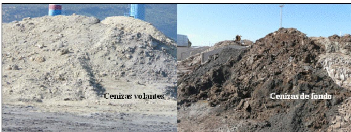
**Figura I.16.** Tipos de cenizas producidas por la combustión de biomasa residual.
