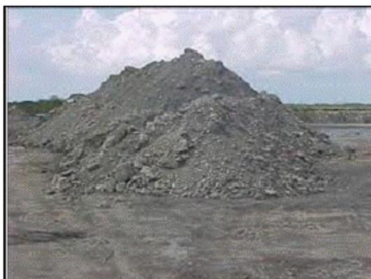
**Figura I.17.** Cenizas volantes producidas por la combustión de carbón en centrales térmicas.
