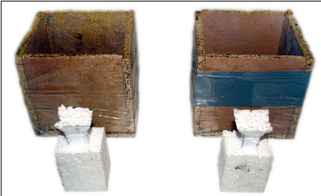
**Figura A1.79.** Modelos realizados en poliestireno expandido y cajas de conglomerado para la prueba de fundición.
