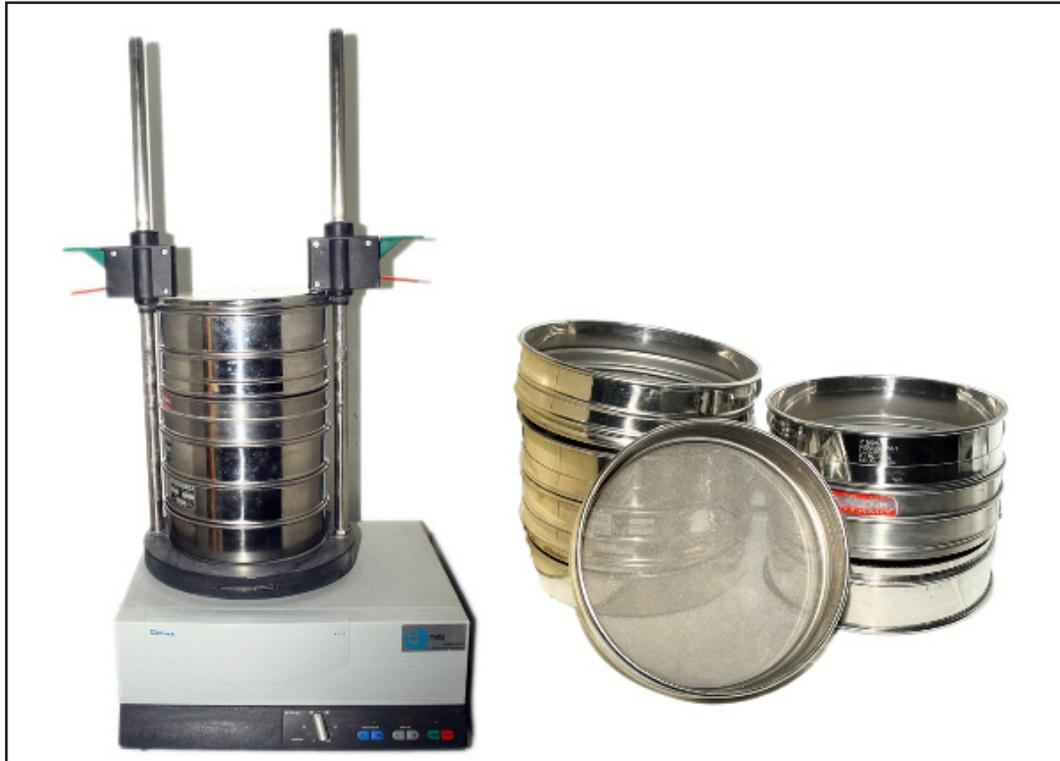
**Figura A1.27.** Tamizadora analítica Retsch AS 200 Digit y batería de distintos cedazos o tamices empleados en la criba de material molido.
