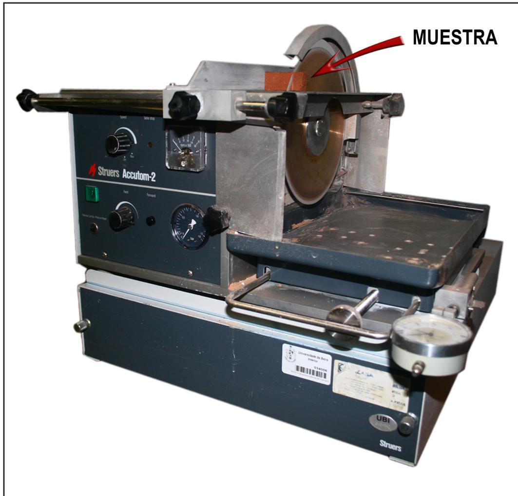
**Figura 8.1.** Máquina de Corte Struers Accutom-2 con un disco de corte de diamante Struers M4D18 176 x 0,8 x 12,7 mm.
