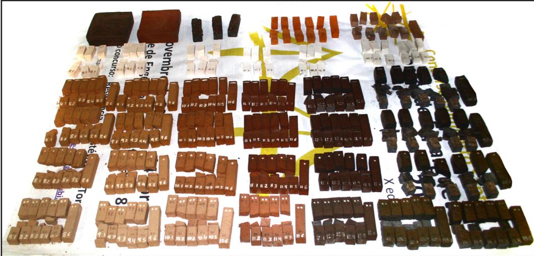
**Figura 7.1.** Panorámica de las muestras de ensayo sometidas al ensayo de flexión en 3 puntos.
