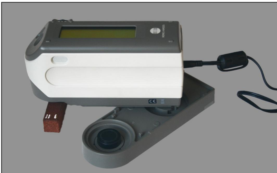
**Figura A1.1.** Espectrofotómetro CM-2500c Konica Minolta empleado en las mediciones
