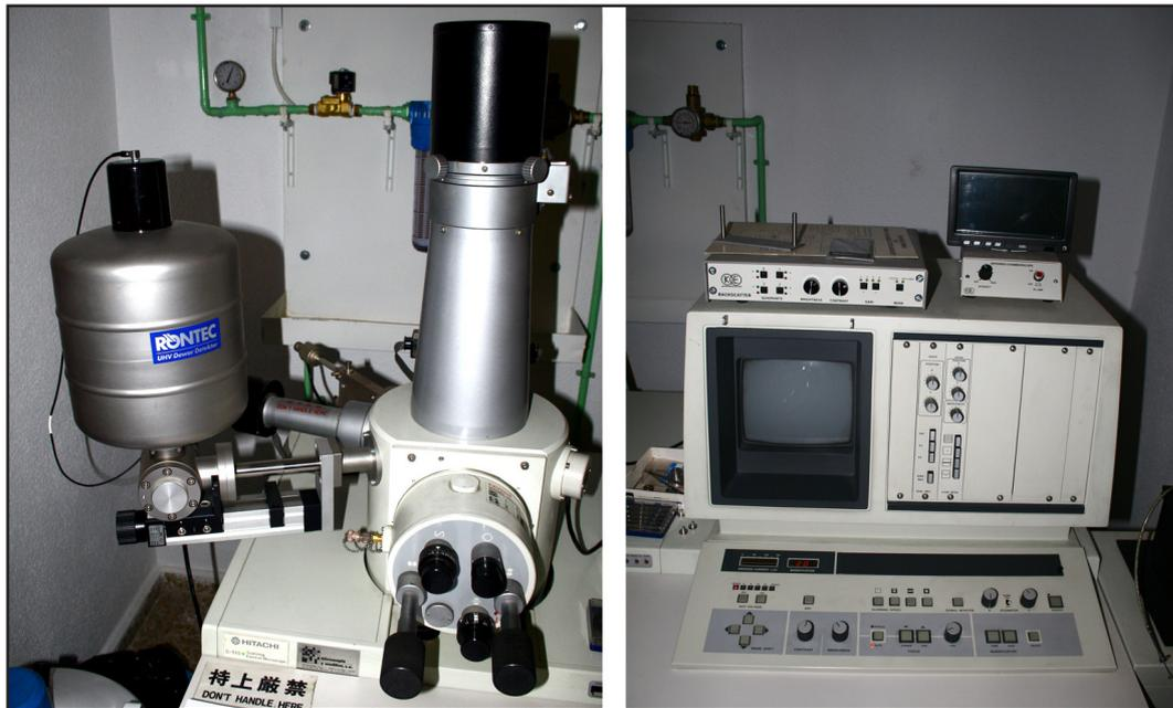
**Figura 9.1.** Equipo de microscopía electrónica de barrido del CIC de la UGR, compuesto por el sistema de iluminación formado por el cañón de electrones, un conjunto de lentes condensadoras y el sistema de deflexión responsable del barrido del haz de electrones, el portamuestras, los sistemas de detección de las diferentes emisiones y el sistema de visualización de la imagen.
