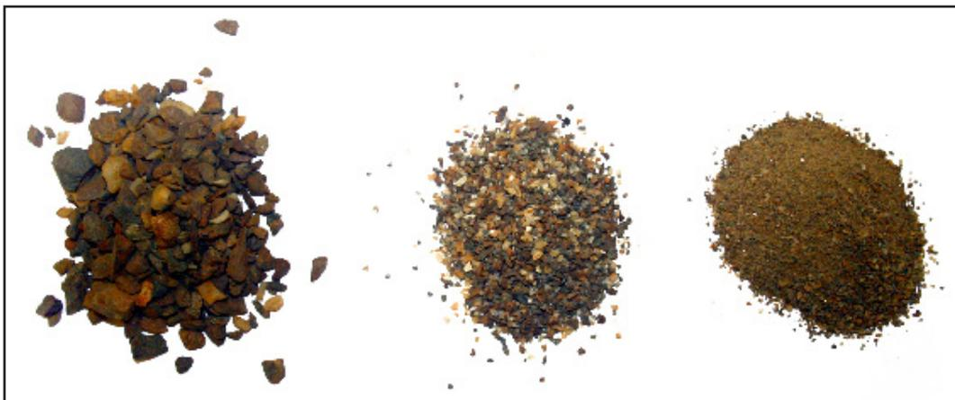
**Figura A1.24.** Distintas granulometrías del árido: mayor de 2 mm, entre 2 mm y 0,6 mm y menor de 0,6 mm, respectivamente.
