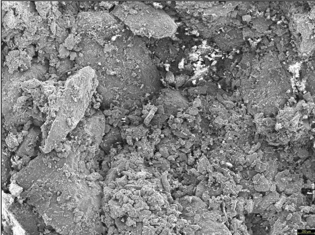
**Figura A1.72.** Imagen de SEM a 30x de la muestra PAN R FEN. Plano general donde se observa su granulometría heterogénea y su notable porosidad.
