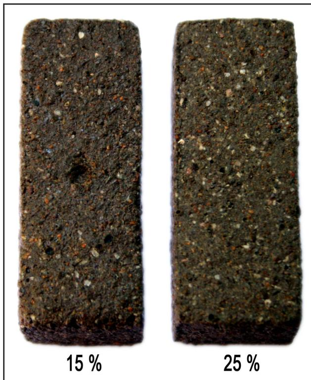
de la mezcla, y conformando, con la ayuda de un listón de madera, dos probetas de dimensiones aproximadas a 4 x 1 x 1 cm. Al ser dos pruebas iniciales para comprobar si esta mezcla era mejor aparentemente que los compuestos anteriores, la proporción de agua se ha cuantificado de manera aproximada.
