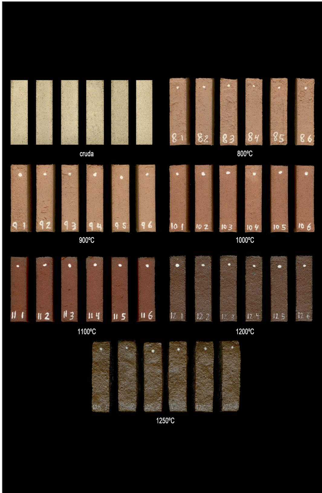
**Figura 3.11.** Imagen realizada a partir de escaneo directo de las probetas al 25% de caolín tras sus respectivas hornadas y muestra fotográfica del color de las probetas crudas. Los tamaños de unas probetas con respecto a otras se corresponden totalmente con la relación real de las mismas.
