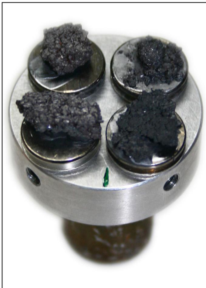
Previamente al análisis con SEM, las muestras (figura 9.2) fueron pegadas al soporte circular con una pasta especial de carbono (también se puede utilizar un pegamento de plata coloidal) asegurando la conductividad y manteniendo el potencial eléctrico de la muestra a 0 durante la observación. Posteriormente fueron recubiertas por evaporación con una película conductora de oro/paladio.
