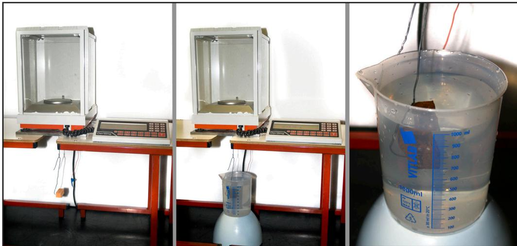
**Figura 10.2.** Balanza Oertling VA204 con capacidad hasta 200g y resolución de 0,0001g con la que se han realizado las pesadas tanto en seco (izquierda) como inmersa y saturada (centro y derecha).
