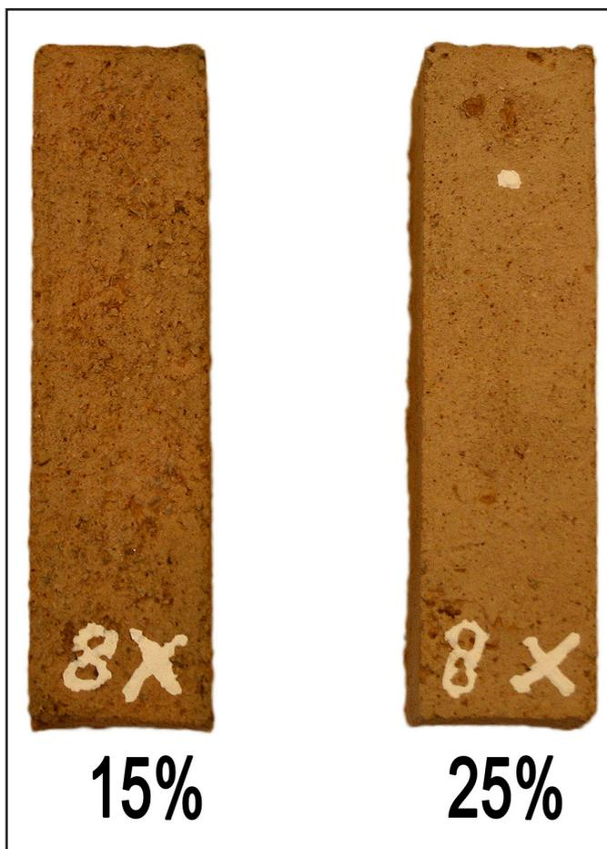
De todo ello se deduce que el agua de amasado o mezclado de las probetas es determinante para la mayor o menor cohesión de la mezcla, encontrando, para las probetas aglomeradas al 15% y al 25%, el equilibrio adecuado en el 20% de agua en volumen, precisando, no obstante, 24 horas de secado en el molde tras su confección antes de efectuar su extracción.
