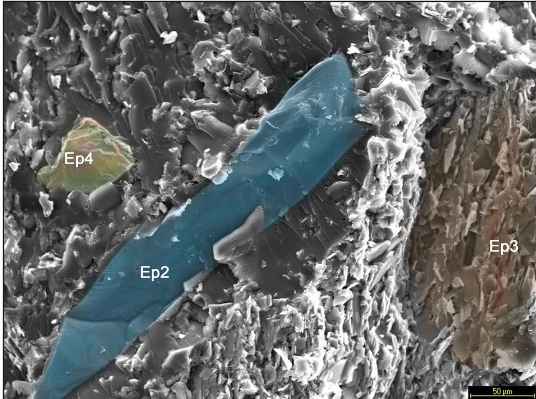
**Figura 9.98.** Imagen de SEM a 300x del árido PAN sin estar sometido a tratamiento térmico. Detalle diversos minerales englobados en la matriz: cuarzo, moscovita y formación con arsénico, azufre e hierro.
