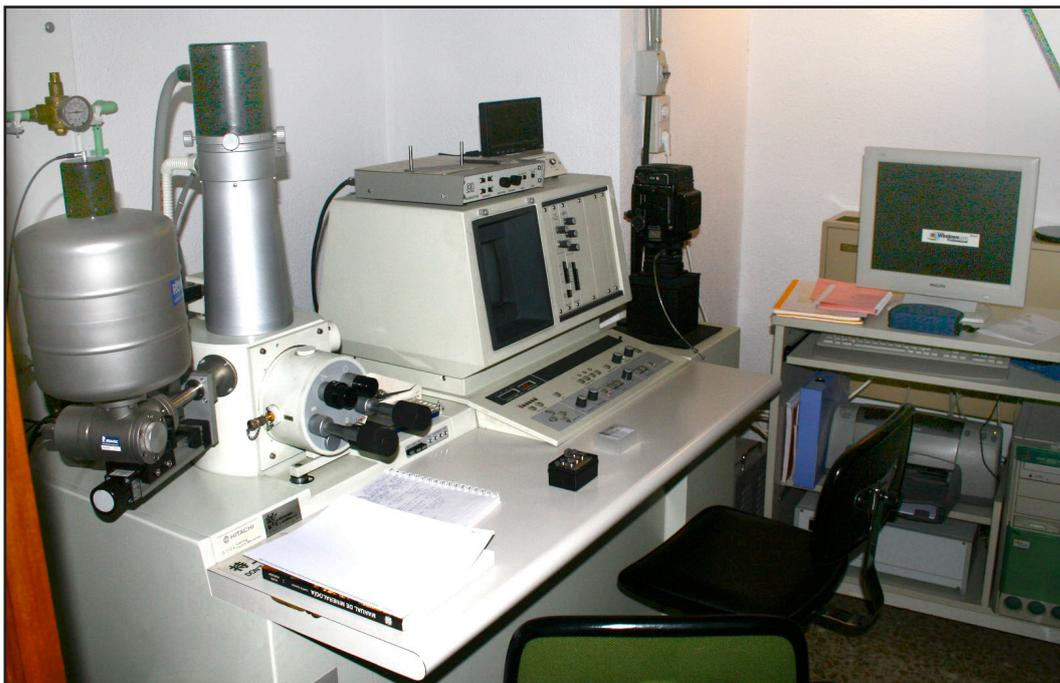
**Figura A1.29.** Equipo de microscopía electrónica de barrido del CIC de la UGR, compuesto por el sistema de iluminación formado por el cañón de electrones, un conjunto de lentes condensadoras y el sistema de deflexión responsable del barrido del haz de electrones, el portamuestras, los sistemas de detección de las diferentes emisiones, el sistema de visualización de la imagen, y el ordenador al que son transferidas.
