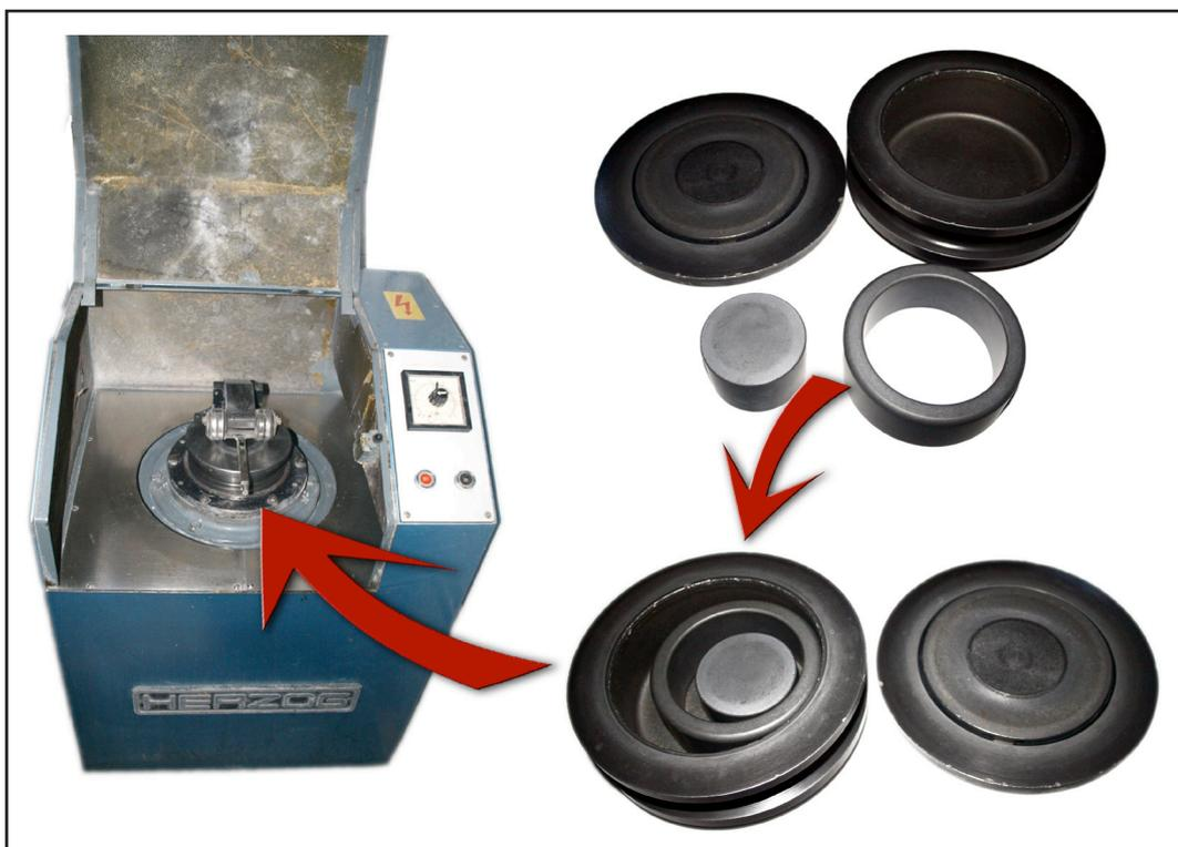
**Figura A1.25.** Molino de discos vibratorio Herzog, empleado en la molienda de material pétreo y discos de molienda utilizados.
