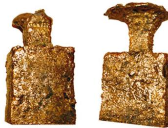
Fig. 8. Peças de bronze depois de retiradas da caixa de moldação.
