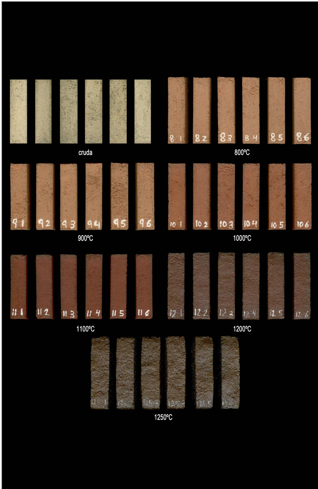
**Figura 3.10.** Imagen realizada a partir de escaneado directo de las probetas al 15% de caolín tras sus respectivas hornadas y muestra fotográfica del color de las probetas crudas. Los tamaños de unas probetas con respecto a otras se corresponden totalmente con la relación real de las mismas.
