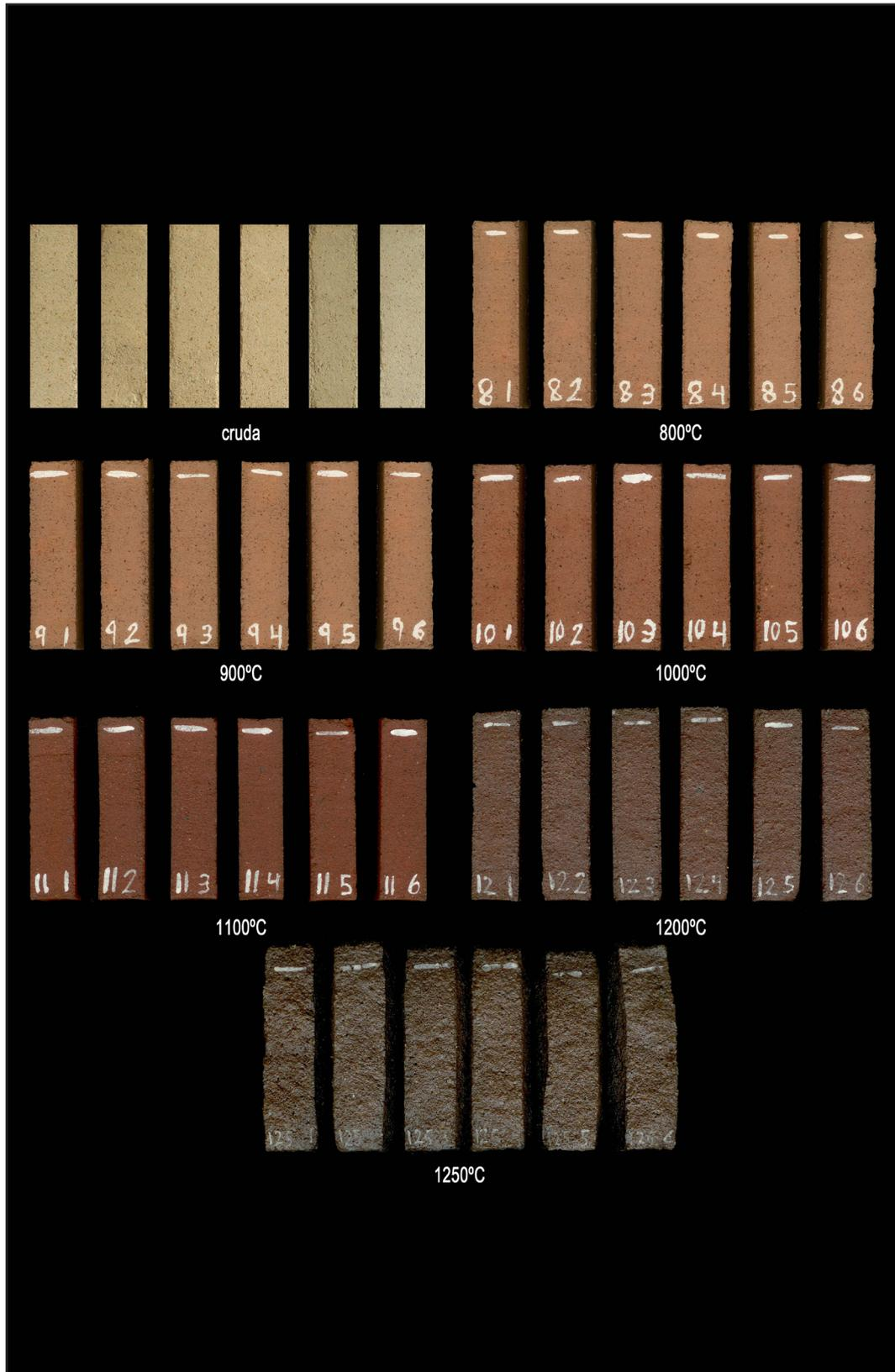
**Figura 3.9.** Imagen realizada a partir de escaneado directo de las probetas al 10% de caolín tras sus respectivas hornadas y muestra fotográfica del color de las probetas crudas. Los tamaños de unas probetas con respecto a otras se corresponden totalmente con la relación real de las mismas.
