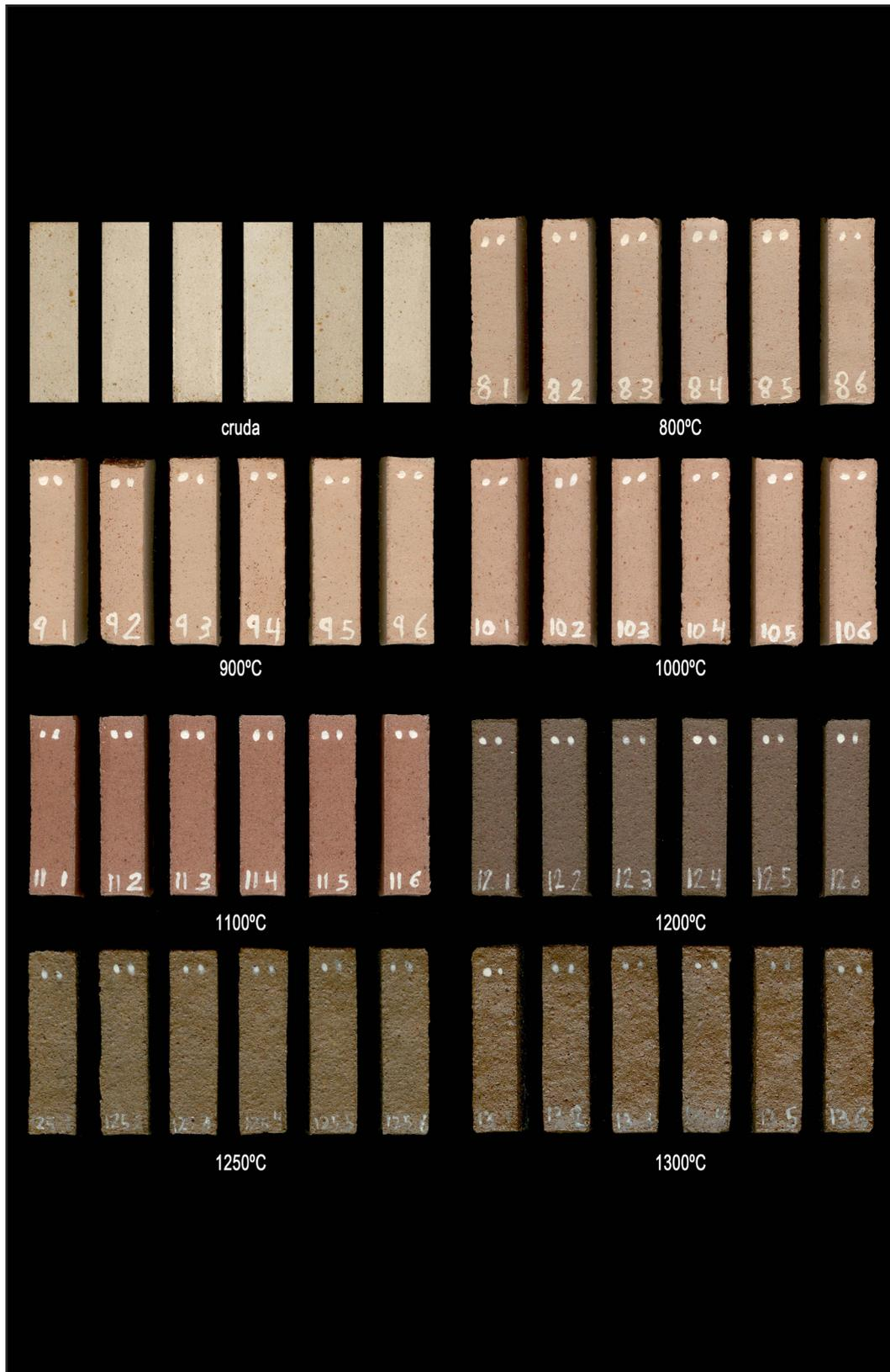
**Figura 3.11.** Imagen realizada a partir de escaneado directo de las probetas al 50% de caolín tras sus respectivas hornadas y muestra fotográfica del color de las probetas crudas. Los tamaños de unas probetas con respecto a otras se corresponden totalmente con la relación real de las mismas.
