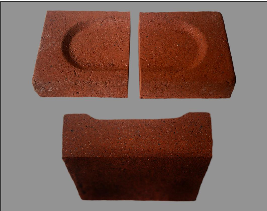
**Figura 13.3.** Corte del ladrillo en 2 mitades e imagen de la sección. Nótese la buena compactación sin grandes irregularidades ni bolsas de aire.
