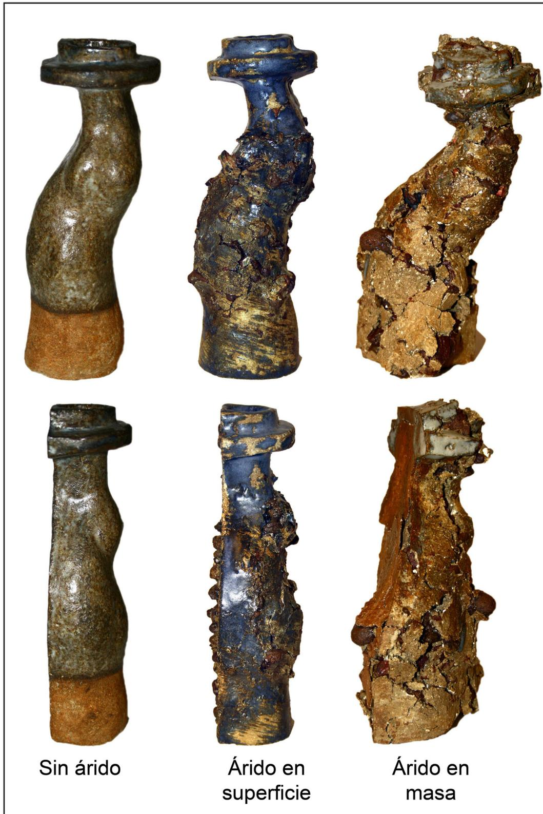
**Figura 13.29.** Vista frontal y lateral de tres piezas de 19,5 cm de altura, realizadas mediante apretón y cocidas a 1260°C, de izquierda a derecha: mezcla de pastas refractarias sin árido PAN, misma mezcla de pastas con el árido utilizado en incrustaciones superficiales, y misma mezcla de pastas con el árido utilizado en la composición en masa de la pasta, a modo de desgasante. Nótese la variación volumétrica y textural según el uso del árido. Realizadas por Durán Suárez y Montoya Herrera.
