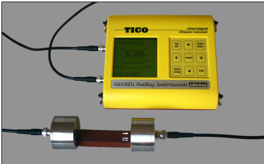
**Figura 6.2.** Aparato de Ultrasonidos Tico Proceq empleado para el ensayo mediante transmisión directa.
