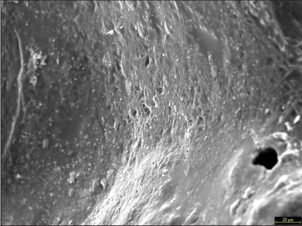
**Figura 9.82.** Imagen de SEM a 500x de la muestra PAN 50% a 1300°C, aumento de la cara interna de una vacuola o burbuja.
