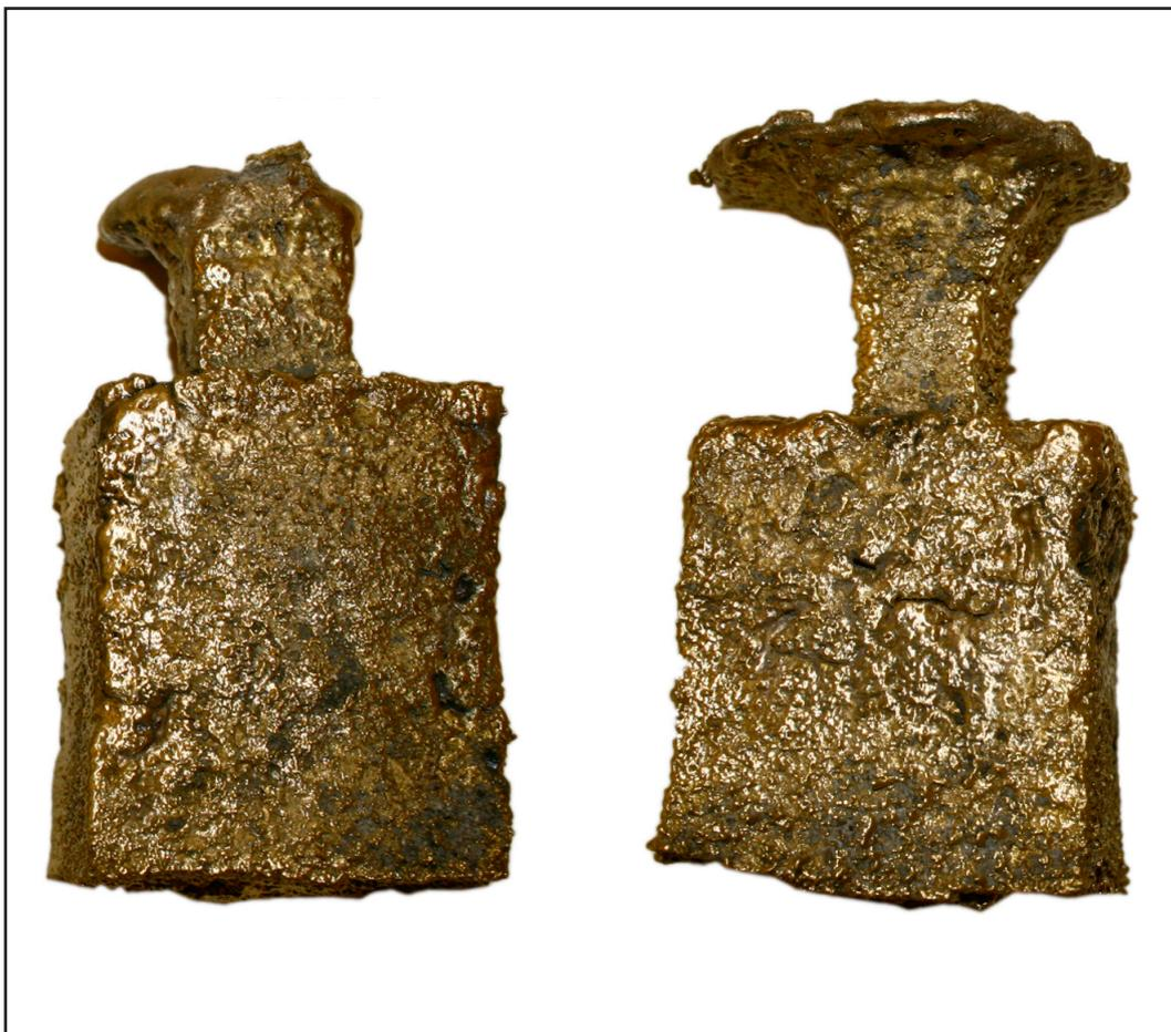
**Figura A1.83.** Vaciados tras limpieza de restos de arena (mezcla al 15% de arcilla refractaria a izquierda y mezcla al 25% a derecha) donde se aprecia la calidad de la copia, cuyos pequeños defectos son debidos no a la calidad del árido sino al exceso de humedad empleado.
