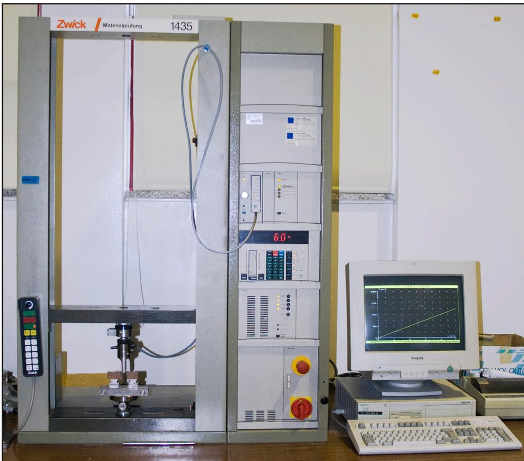
**Figura 7.2.** Máquina de Ensayos Mecánicos Universales Zwick 1435, con la que se han realizado los ensayos de flexión y compresión.
