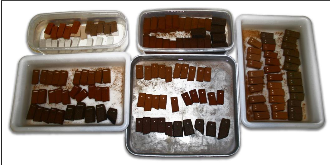
**Figura 10.3.** Probetas sumergidas en agua para la pesada saturada, la cual se ha realizado a las 3h, 6h, 12h, 24h, 48h, 72h y 96h, siendo éste último el valor definitivo.
