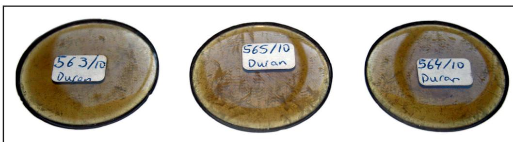
**Figura A1.26.** Perlas sólidas de árido PAN fundidas con tetraborato de litio preparadas para su análisis mediante FRX.
