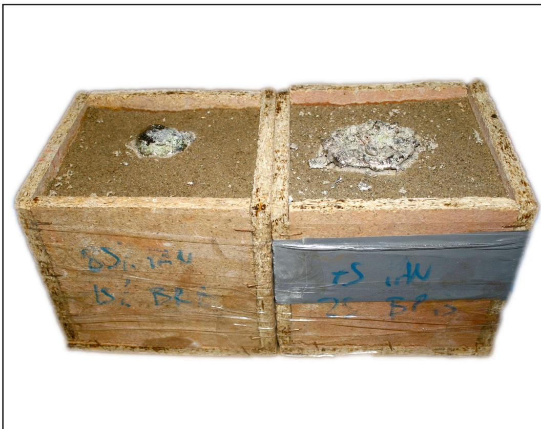
**Figura A1.81.** Cajas de contención para el árido, tras la colada del bronce.
