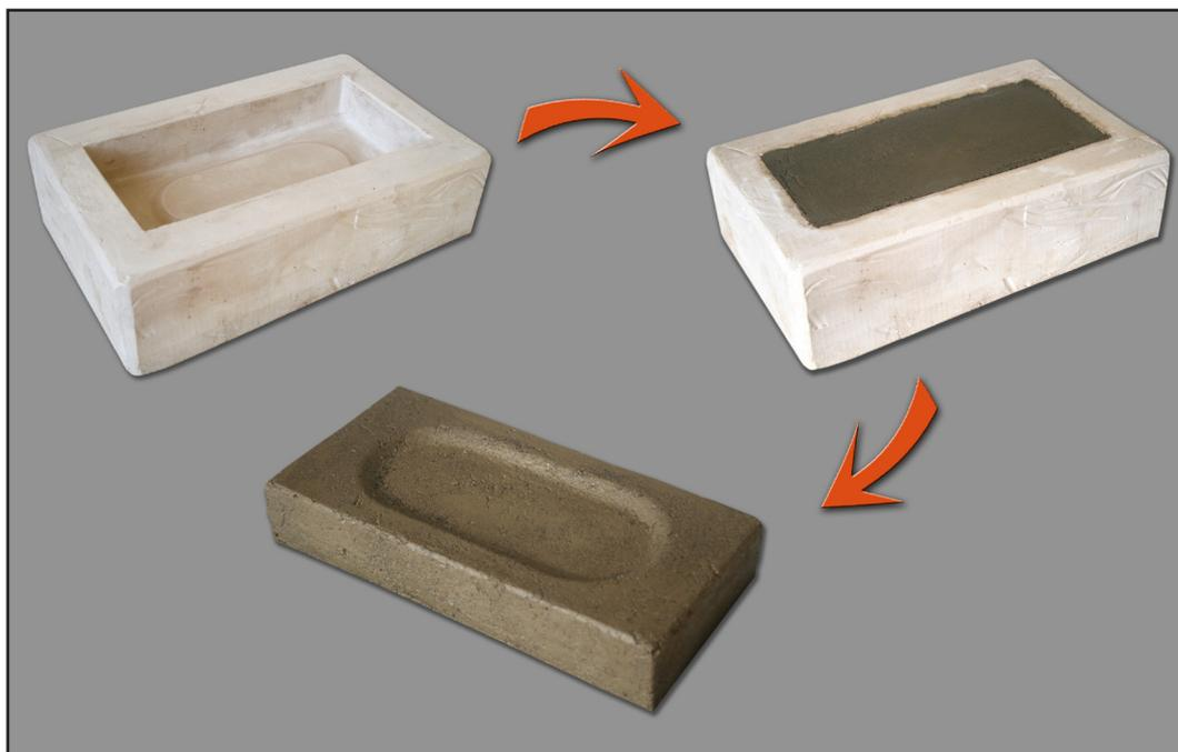
**Figura 13.1.** Proceso de realización de ladrillo macizo con pasta PAN al 25% a partir de molde de escayola mediante técnica de “apretón”.
