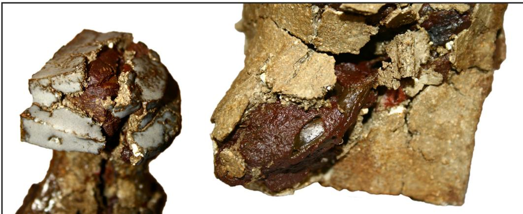
**Figura 13.31.** Detalle de fusión parcial del árido usado en la composición en masa en un cuerpo cerámico, modificando y deformando el aspecto inicial de la pieza.
