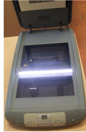
El escáner básico consta de un brazo que proyecta un haz de luz, provisto de un sensor que capta el reflejo del documento original. En la mayoría de los escáneres este brazo es móvil y se desplaza a lo largo del documento. Se denomina dispositivo de carga acoplado (*coupled charge device*). Este proceso se llama barrido o *raster* (en inglés). La información recibida de esta forma es codificada por un procesador, que puede modificar la imagen o transmitirla directamente al ordenador.
