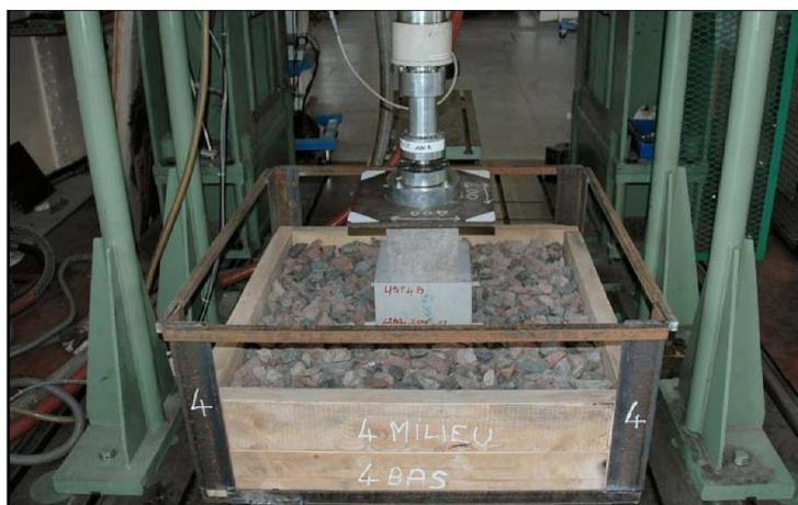
Figura 59: Aspecto de un cajón de balasto comúnmente utilizado en ensayos de laboratorio para evaluar suelas elásticas (UIC Project Under Sleeper Pads, 2009).
