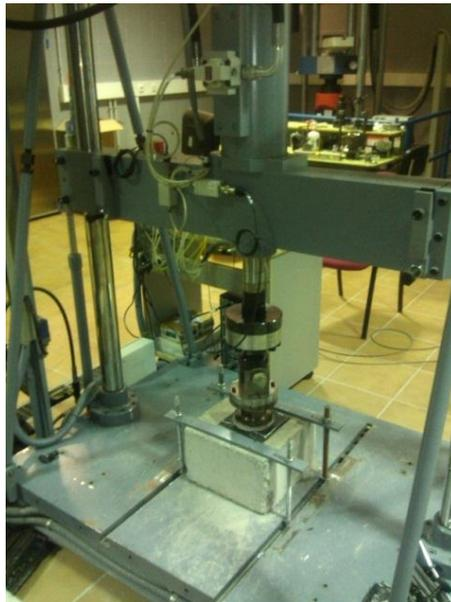
**Figura A 14: Configuración del ensayo desarrollado para medir la resistencia al arrancamiento de suelas.**
