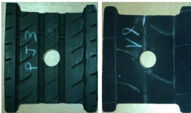
Figura 107: Placas de neumáticos con geometrías particulares.
