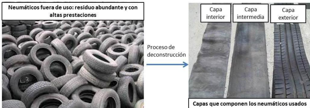
Figura 88: Deconstrucción en capas de neumáticos usados. Banda interior (izquierda), intermedia (centro) y externa (derecha).
