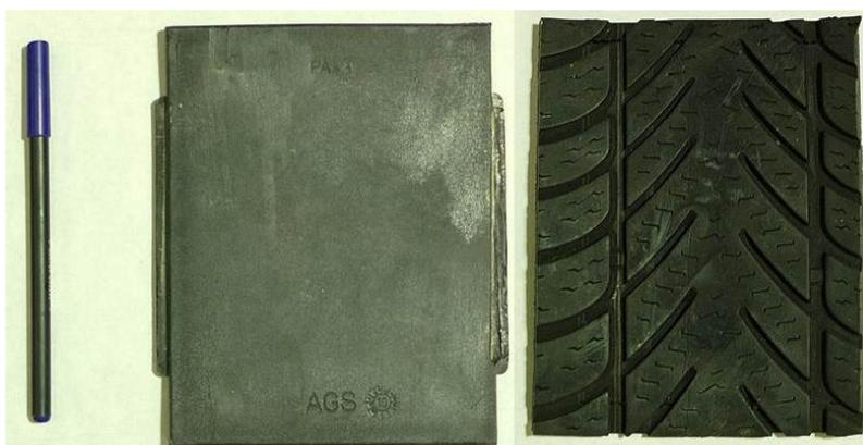
Figura 160: Aspecto visual del tipo de placas utilizadas en vías de EuskoTren (izquierda) y aspecto de placas de neumáticos usadas en el tramo de prueba (derecha).
