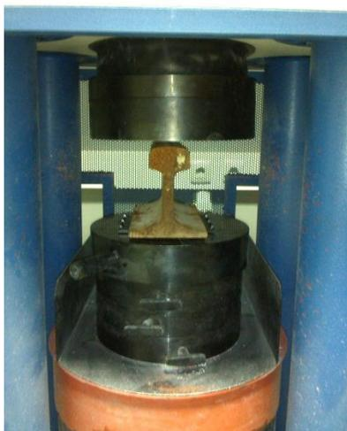
**Figura A 9: Equipo utilizado en el ensayo de compresión.**
