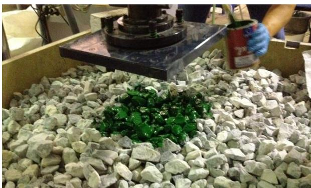
**Figura A 13: Aplicación de pintura sobre las partículas de balasto, con el fin de medir el área de contacto entre suelas/traviesas y balasto.**
