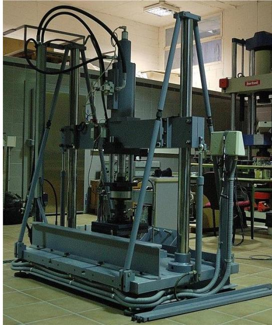
**Figura A 16: Configuración del equipo utilizado para evaluar la respuesta dinámica de mantas.**
