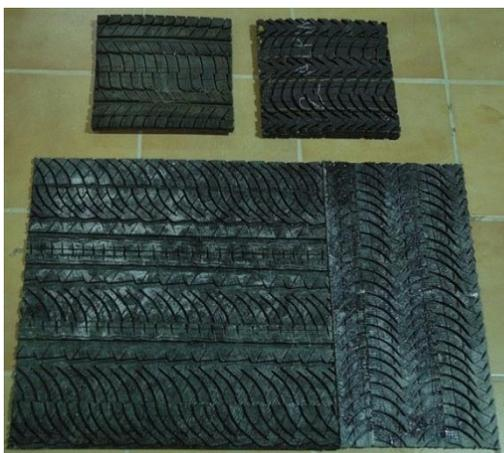
**Figura 113: Muestras de mantas elásticas (2 muestras de 300x300 mm, y una de 900x900 mm) para su ensayo en laboratorio.**
