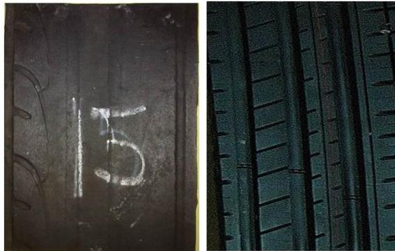
**Figura 91: Muestras de neumáticos con distinto nivel de desgaste.**
