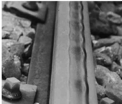
**Figura 17: Aspecto visual del fenómeno de corrugación de carril (Egana et al., 2006).**
