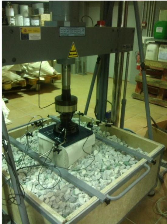
**Figura 98: Disposición de los elementos empleados en el ensayo de fatiga para suelas elásticas.**
