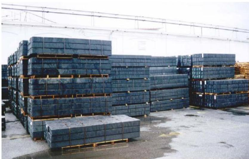
**Figura 82: Traviesas fabricadas a partir de caucho reciclado y otros plásticos (Anne and Russ Evans, 2006).**
