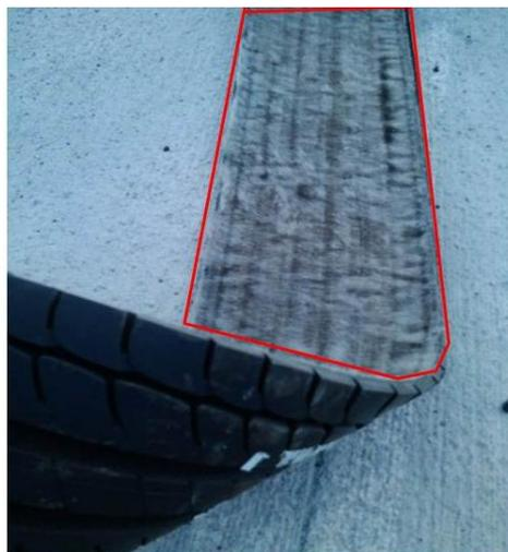
**Figura 112: Tejido textil extraído en la cara interna de la banda de rodadura.**
