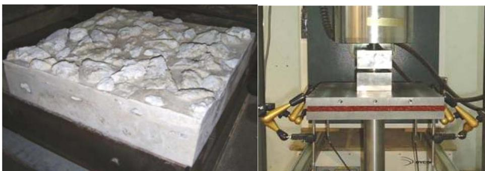
**Figura 80: Aspecto visual de distintos métodos de ensayos en laboratorio para mantas. Empleando capa de balasto (izquierda) y utilizando placas planas de carga (derecha) (Carrascal et al., 2013).**
