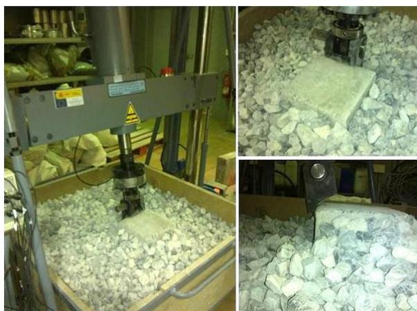
**Figura A 12: Configuración del ensayo realizado para evaluar la resistencia lateral del conjunto.**
