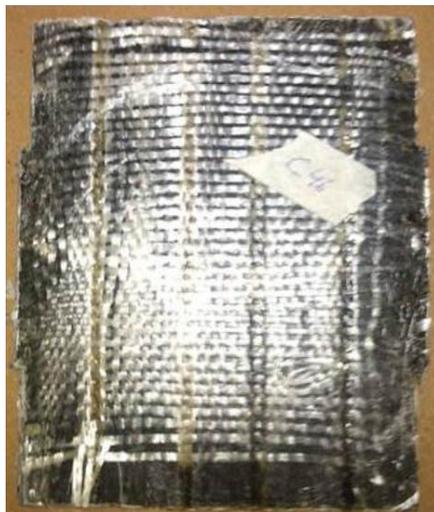
**Figura 162: Aspecto visual del tipo de placas de neumáticos con lámina de fibra, utilizadas en tramos de transición entre las secciones con placas de EuskoTren y la sección con placas de neumáticos sin tratar**
