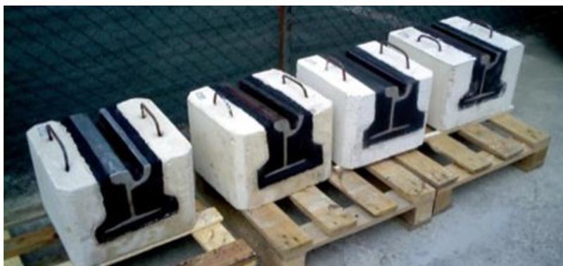
**Figura 85: Carriles embebidos en una mezcla de polvo de neumáticos y resina (Sistema MLG).**
