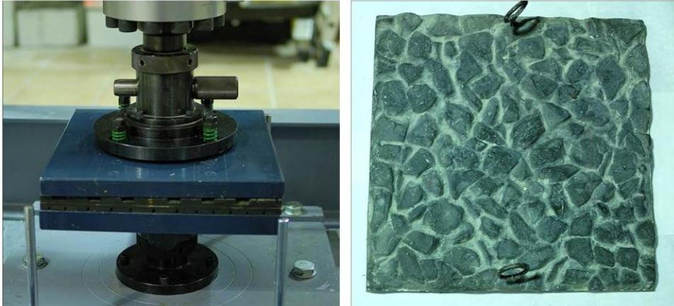
**Figura A 15: Placas planas (izquierda) utilizadas en la norma DBS 918 071-1 para solicitar mantas elásticas, y placas normalizada de balasto (derecha) empleada de acuerdo a la norma DIN 45673-5.**
