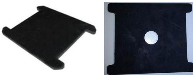
**Figura 84: Placas de asiento obtenidas a partir de polvo de neumáticos (CDM).**
