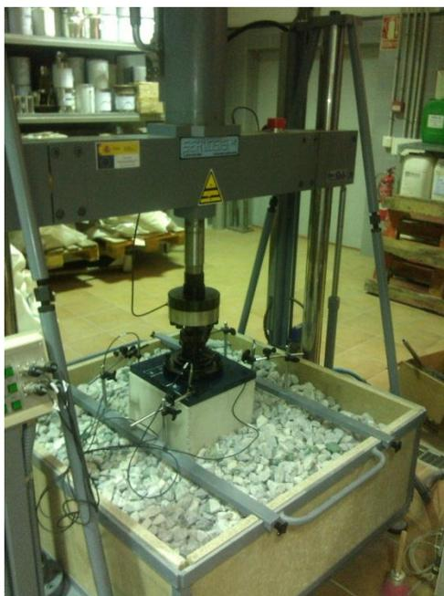
**Figura A 11: Configuración del ensayo de fatiga para suelas sobre cajón de balasto.**
