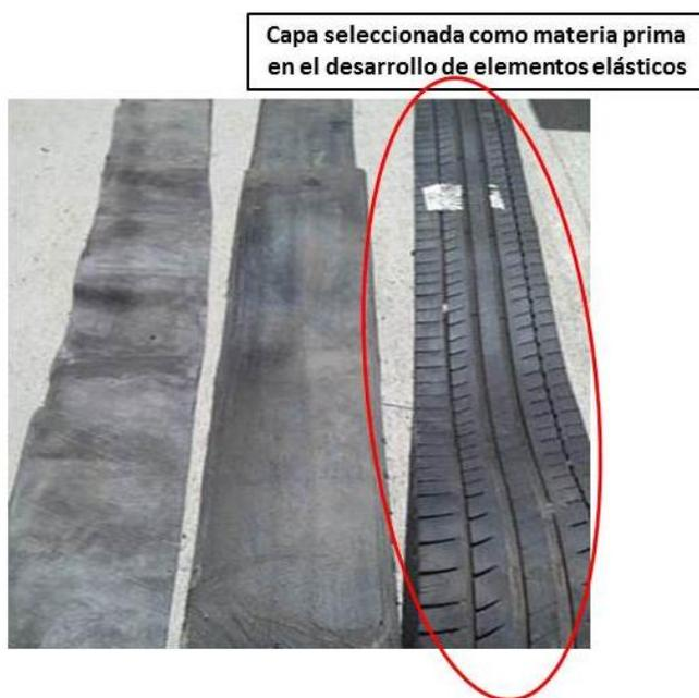
**Figura 104: Capa de neumático seleccionada como materia prima para el desarrollo de elementos elásticos.**
