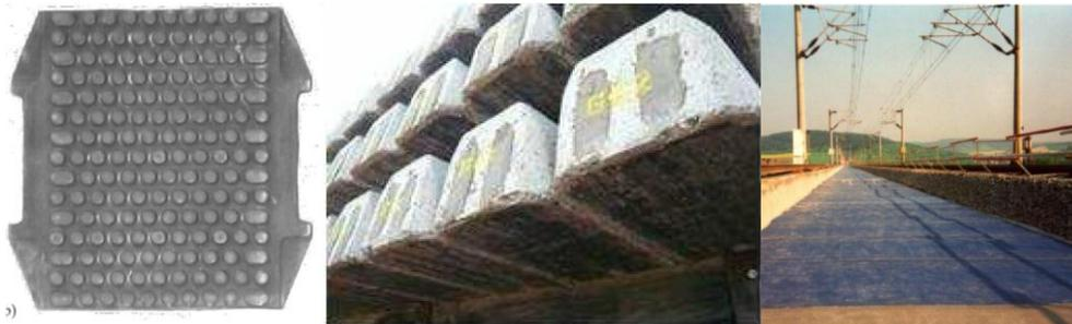
Figura 4: Aspecto visual de placa de asiento (izquierda), suela bajo traviesa (centro) y manta bajo balasto (derecha) (UIC Project, 2006; Kaewunruen y Remennikov, 2009; Bongini, 2012).
