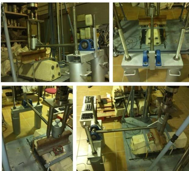
**Figura A 8: Equipo utilizado para el ensayo de atenuación de impactos.**
