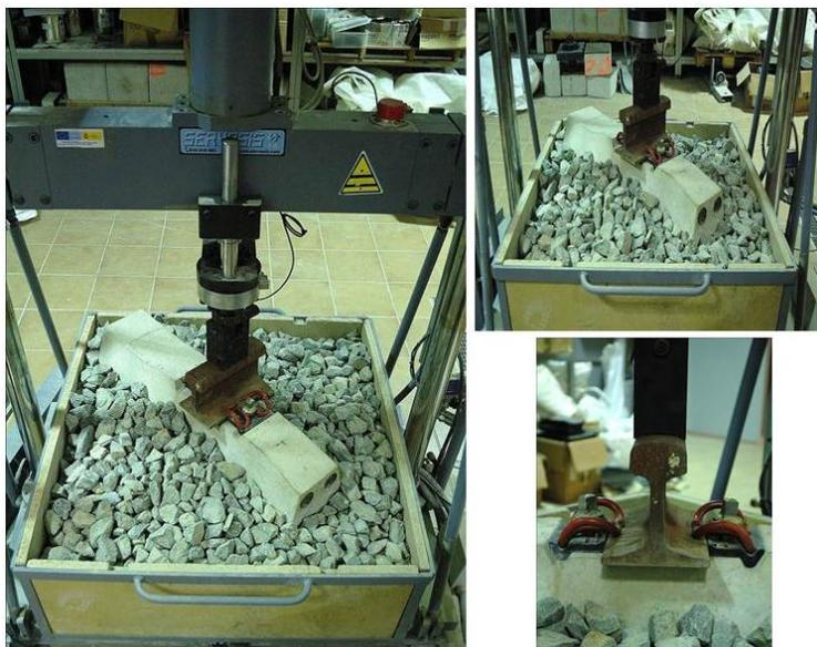
**Figura 100: Configuración del cajón de balasto para simular el comportamiento de una sección de la superestructura de vía.**
