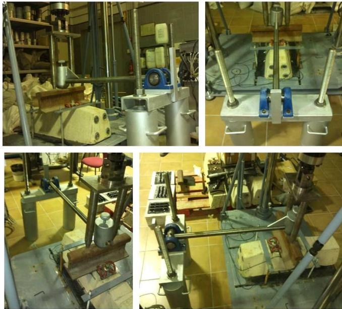
**Figura 102: Diferentes perspectivas de la configuración del ensayo para evaluar la atenuación de impactos por parte de placas de asiento.**
