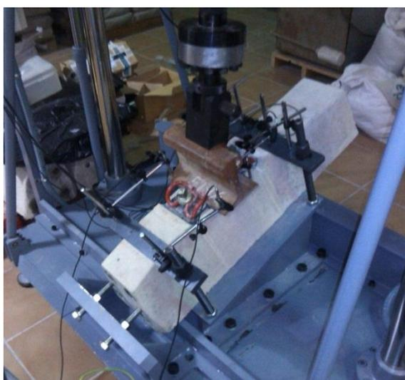
**Figura A 5: Disposición del equipo y los distintos dispositivos para el ensayo de fatiga a carga inclinada.**
