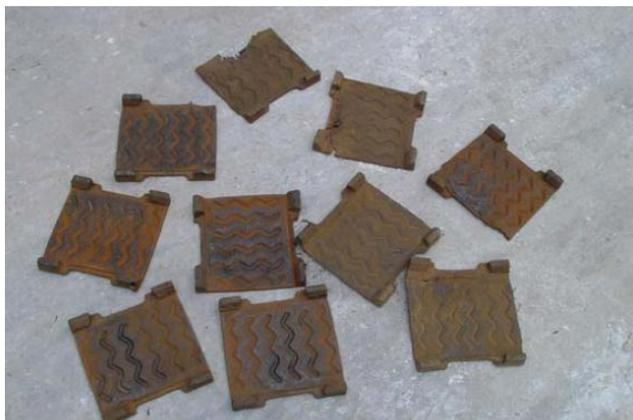
**Figura 51: Aspecto visual de placas degradadas (Kaewunruen y Remennikov, 2005b).**
