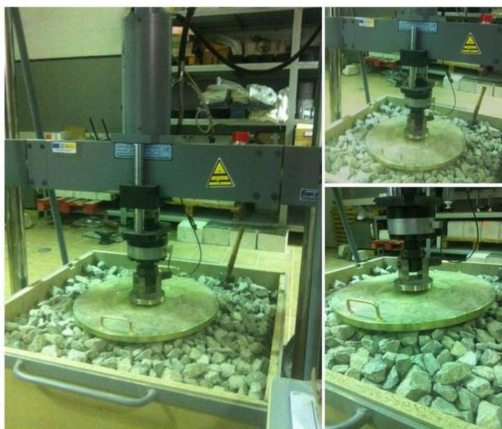
**Figura A 17: Detalle del sistema de aplicación de cargas sobre un cajón de balasto para la fatiga de mantas.**
