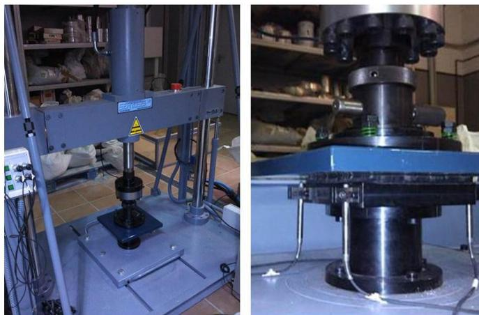
**Figura A 2: Equipo utilizado para determinar la rigidez de las placas de asiento.**
