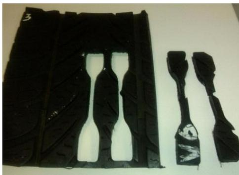
Figura A 1: Probetas para el ensayo de resistencia a la tracción.
