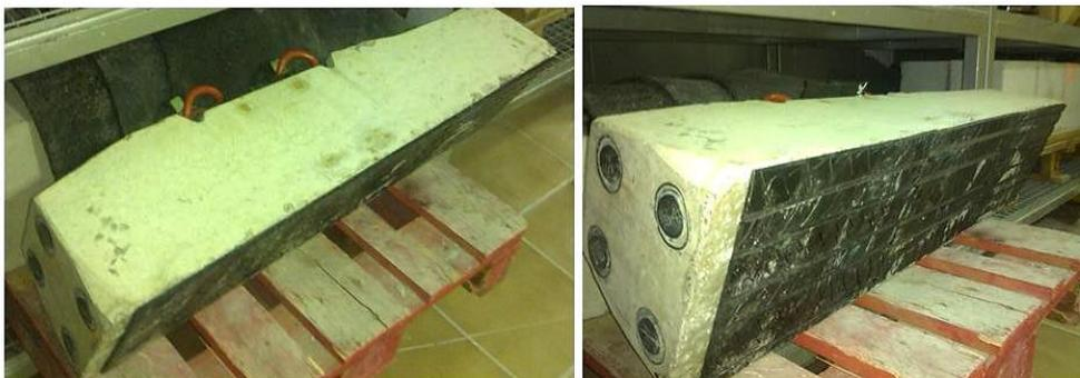
**Figura 111: Media traviesa con suela de neumático adherida en la cara inferior.**
