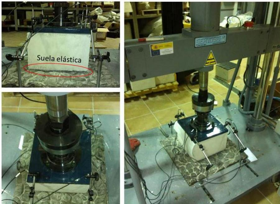
**Figura 94: Configuración de ensayos para suelas elásticas.**
