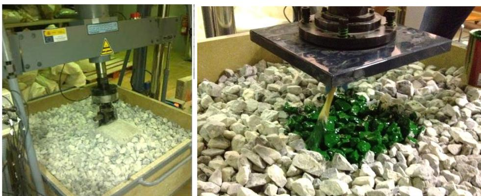
**Figura 103: Aspecto de los ensayos para evaluar la influencia de las suelas en la resistencia lateral (izquierda) y en el contacto traviesa-balasto (derecha).**
