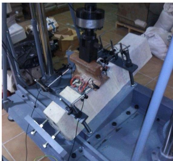
**Figura 97: Configuración del ensayo de fatiga de placas bajo carga inclinada.**
