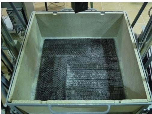
**Figura 114: Cajón de balasto con manta de neumático en el fondo.**
