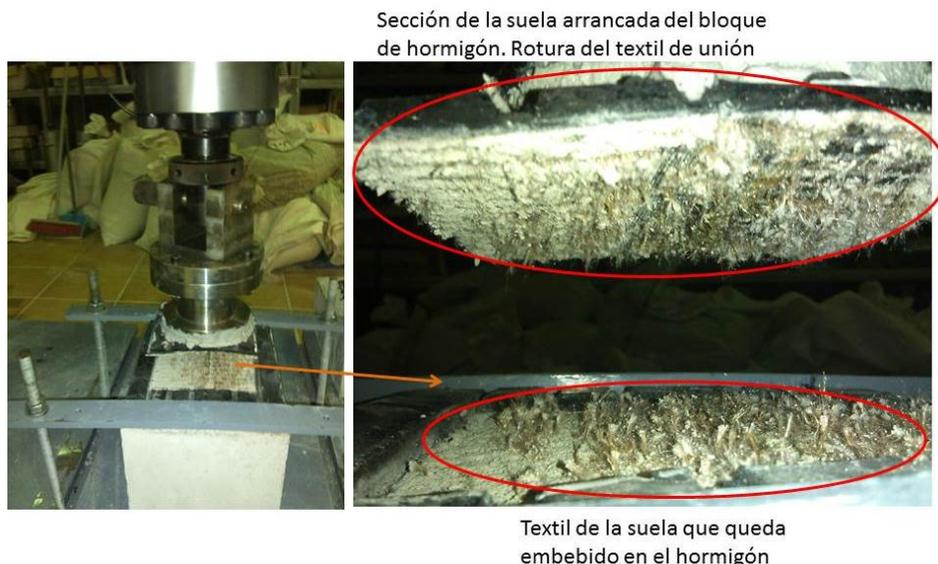
**Figura 131: Aspecto visual de la unión suela-hormigón (con textil embebido en el hormigón) tras el ensayo de arrancamiento.**
