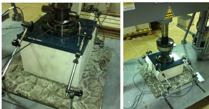
**Figura A 10: Disposición del ensayo para evaluar la rigidez de suelas.**
