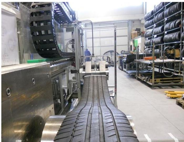
**Figura 86: Proceso industrial de deconstrucción de neumáticos (Gomavial Solutions, S.L.).**
