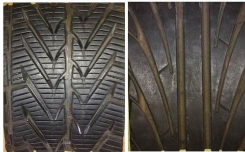
Figura 89: Paneles de neumáticos tipo invierno (izquierda) y tipo común (derecha).
