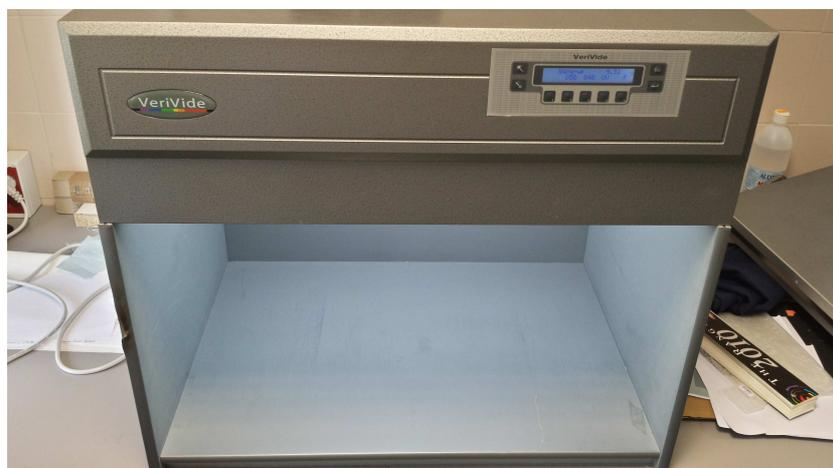
**Figura 3.8:** *Cabina de Observación/Iluminación.*
