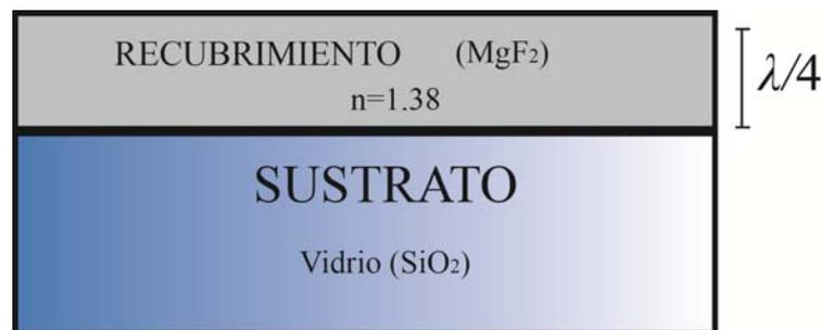
Figura 6.21. Configuración básica de un sistema antirreflectante (© 2003, J. M. Albella, pp. 627).
