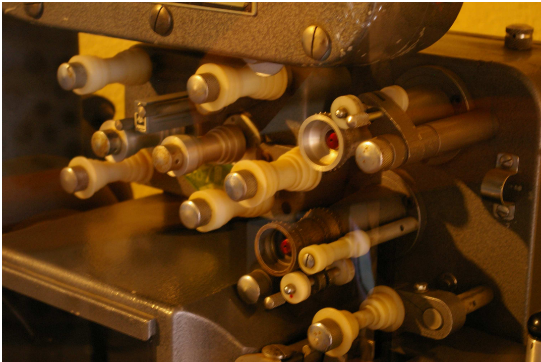
Detalle de la maquinaria un proyector comercial para 35mm. y el juego de bobinas y rodillos que tiran de la película
