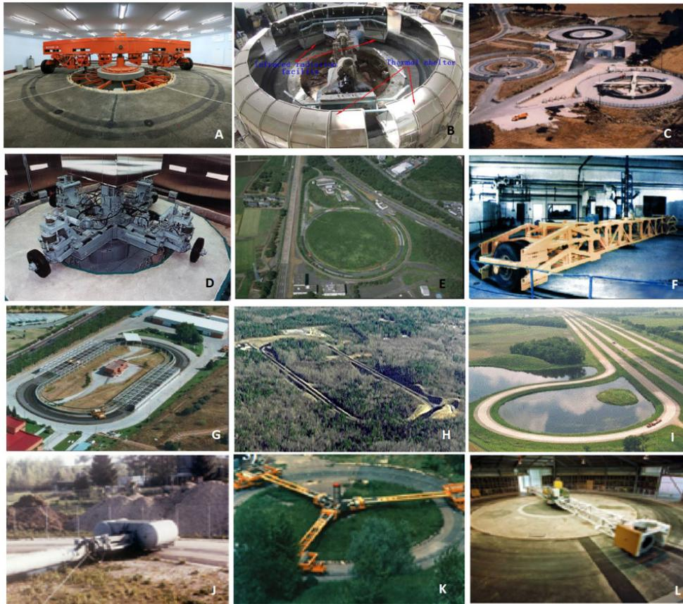
Figura 111. Simuladores de tráfico curvos o mixtos. (AFD40 2011)
