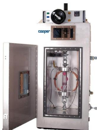
Figura 132. Equipo Cooper para ejecución de la normativa EN 12697-46. (Cooper Technology 2012)
