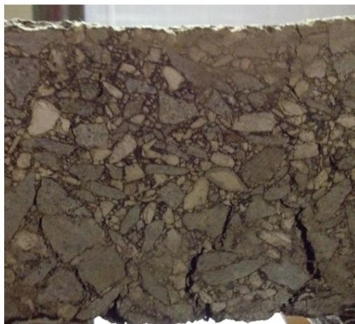
Figura 237. Detalle de las fracturas (ascendentes y descendentes) asociadas a las deformaciones plásticas sufridas por la mezcla AC 16 S ensayada a 40 °C.
