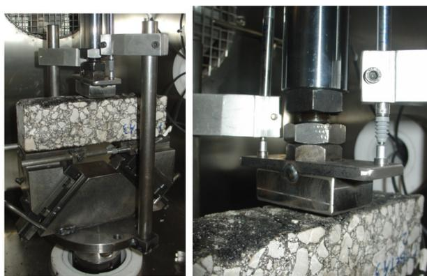
Figura 174. Detalle de posicionamiento de los LVDT para medición de deformaciones verticales sobre el cabezal de carga.
