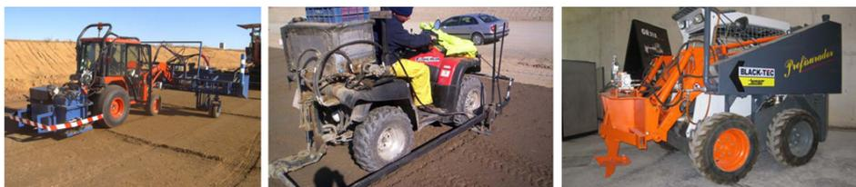
Figura 17. Ejemplos de equipos de prefisurado (Sacyr, Quad prefisurador y dispositivo Black Tec).
