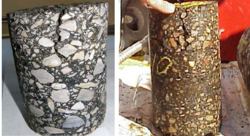
Figura 12. Testigos que muestran la existencia del fenómeno de fisuración descendente (Proyecto Fenix 2010).
