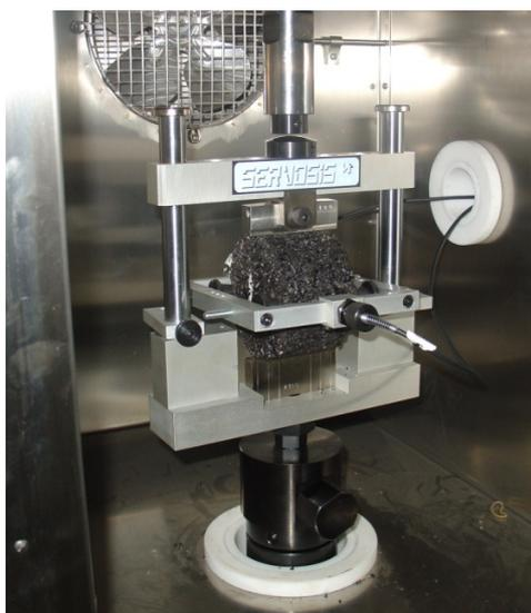
Figura 64. Ensayo de tracción Indirecta.
