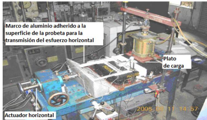
Figura 106. Detalle del ensayo de fisuración de la India. (Bhosale & Mandal 2007)
