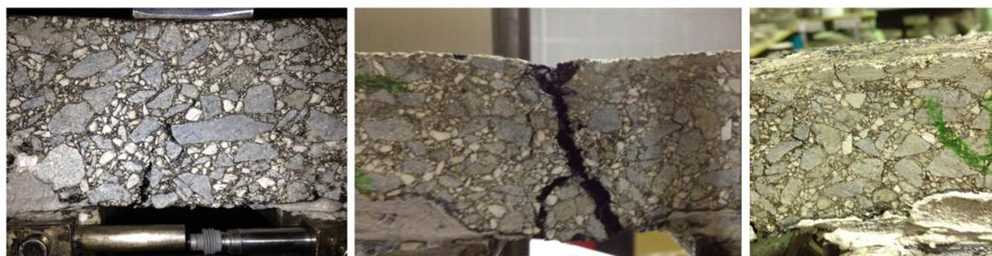
**Figura 232. Detalle del daño por fisuración ramificado y con aparición en ambas direcciones (ascendente y descendente), en mezcla AC 16 S ensayada a 40 °C.**
