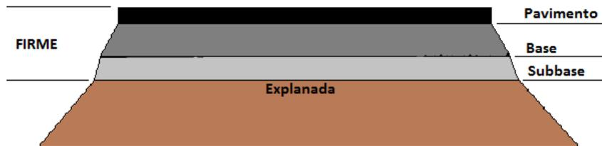
Figura 1. Esquema de las capas del firme.
