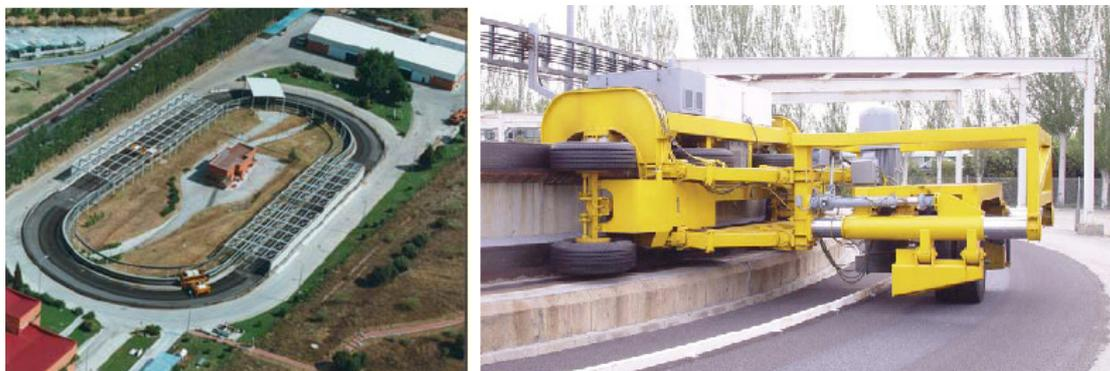
Figura 123. Detalle de la pista de simulación de tráfico del CEDEX.
