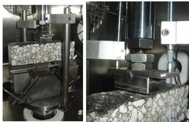
Figura A-I. 4. Detalle del cabezal de carga y de la colocación de los LVDT's de medida verticales.
