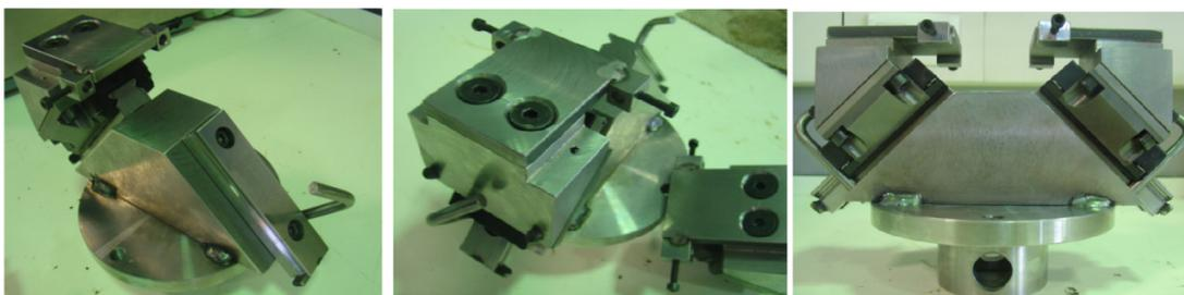
Figura 169. Detalle de la colocación de los carros sobre la base.
