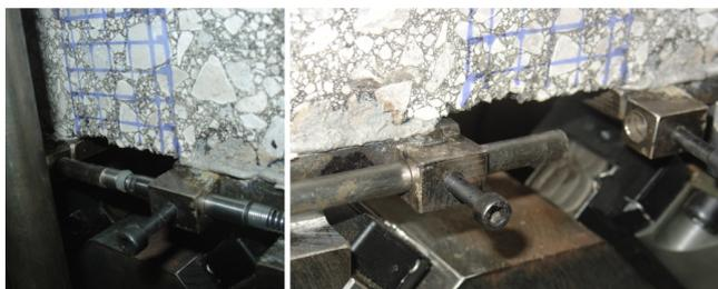
Figura 171. Detalle de colocación de los LVDT horizontales (izq.) y de la varilla de acero utilizada para ello (dcha.).
