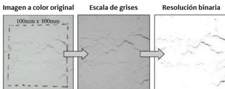
Figura 87. Imágenes obtenidas tras el ensayo del University College de Dublín. (Hartman et al. 2001)
