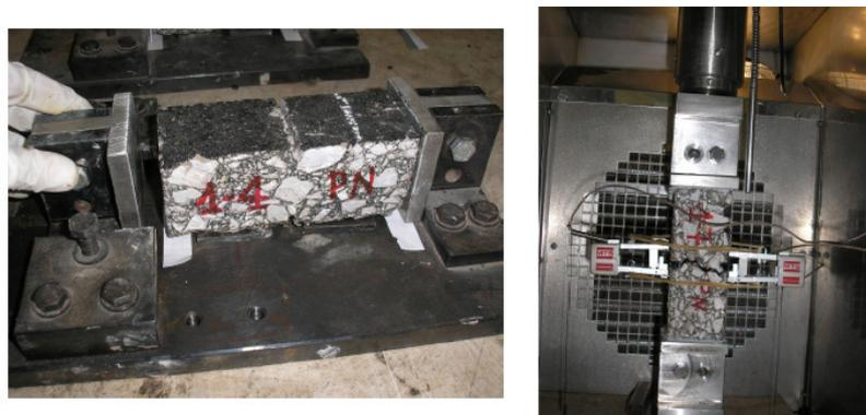
Figura 61. Detalle del ensayo de tracción directa de la UPC. (Pérez Jiménez et al. 2007)
