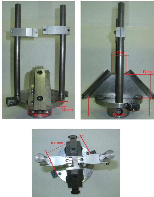
Figura 165. Imagen de alzado, planta y perfil, del dispositivo fabricado.
