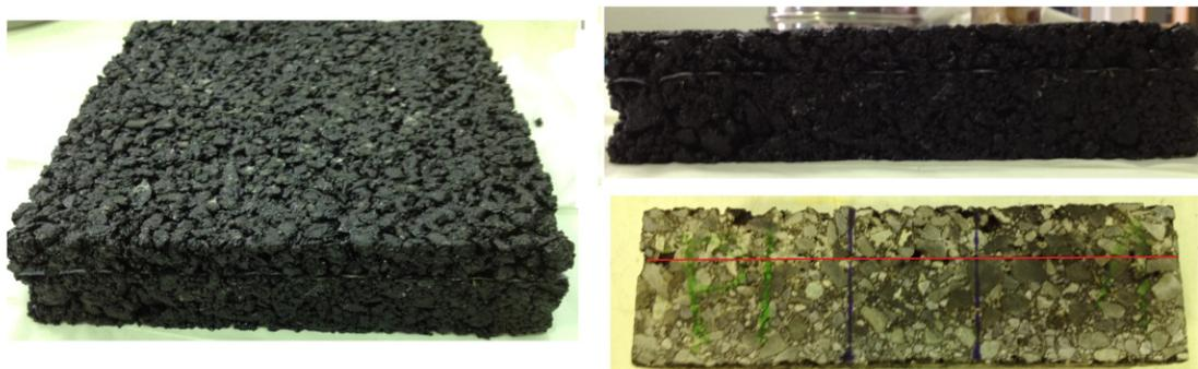
Figura 179. Detalle de probeta compuesta por un micro-aglomerado BBTM 11A en capa de rodadura, un geotextil para retardar la propagación de la fisura, y una mezcla semidensa AC16 S.
