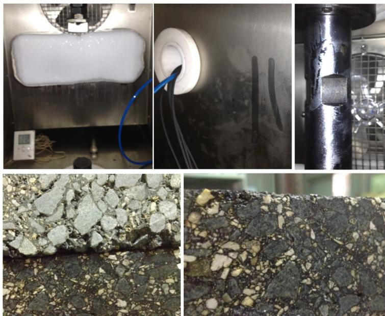
Figura 233. Detalle de los problemas de humedad surgidos durante el ensayo de la mezcla AC 16 S acondicionada a 3 °C. Diferencia de color entre la mezcla afectada por la humedad (abajo) y una seca (arriba).
