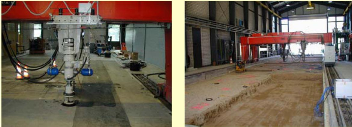
Figura 121. Detalle del sistema de aplicación de carga del simulador de tráfico alemán BAST. (AFD40 2011)
