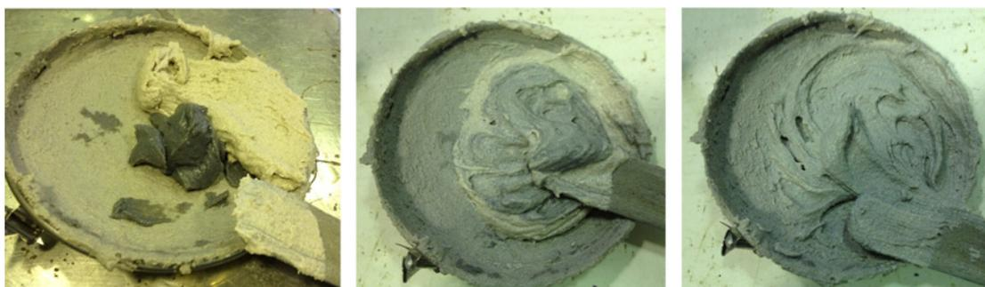
Figura 176. Preparación de la resina epoxi empleada para la fijación de la probeta.
