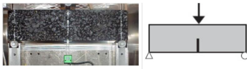
Figura 42. Ensayo a flexión de viga con entalla. (Wagoner et al. 2005b)
