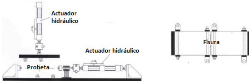
Figura 70. Esquema ensayo de cizallamiento de la Universidad de Delft. (De Bondt 1999)
