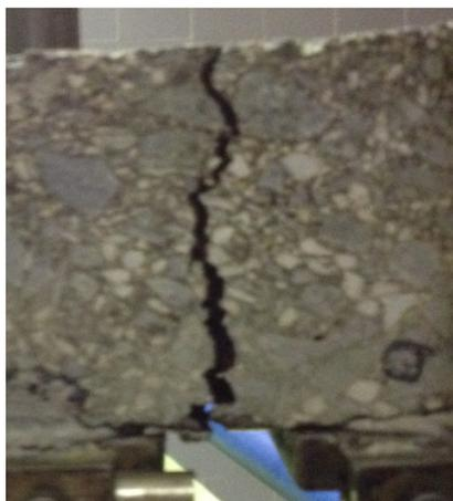
Figura 241. Detalle de la propagación más rectilínea y vertical de la fisura cuando el ensayo se lleva a cabo a una distancia de 15 mm.
