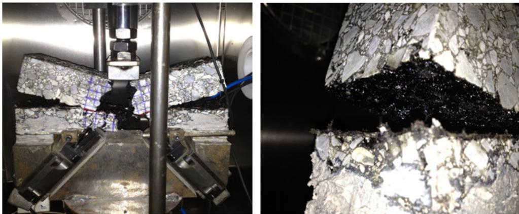
Figura A-II. 8. Detalle del fallo por cortante de la probeta fabricada y la consecuente separación entre capas.
