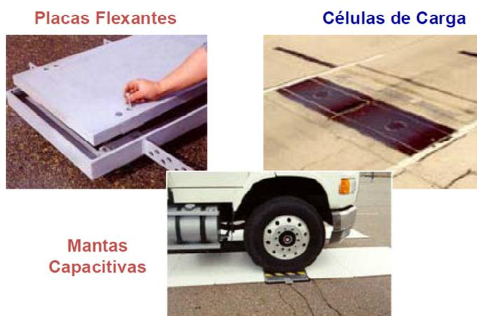
Figura 183. Instrumentos de medición de aforos de peso dinámicos. (Marcobal 2012)
