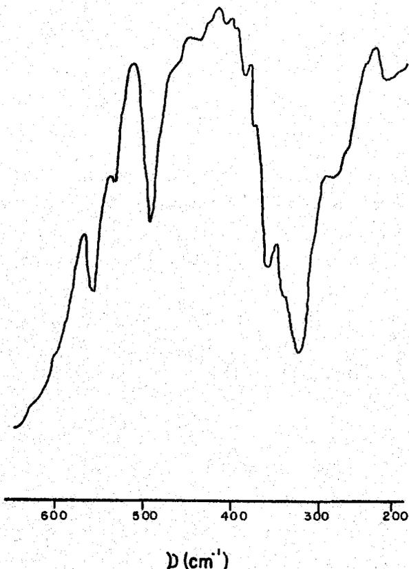
FIGURA 5.13.- Espectro I.R. en polietileno del complejo  $\text{Hg(MTH)Cl}_2$
