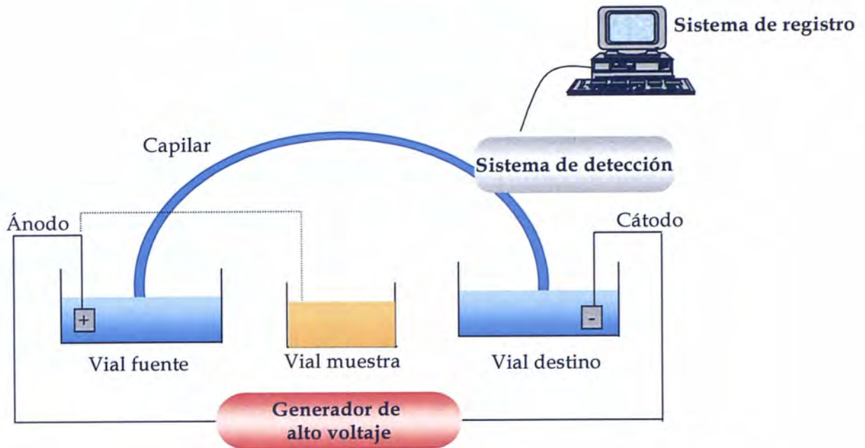
Figura 1. Componentes básicos de un equipo de CE.
