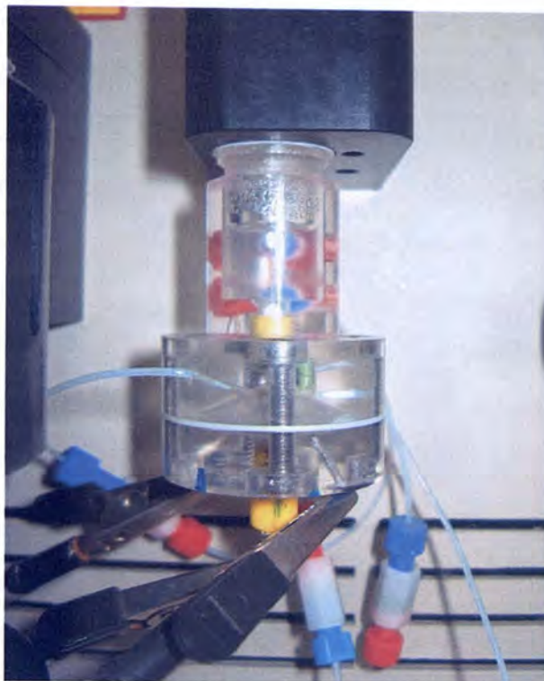
Figura V.10. Imagen de la célula de medida adaptada al equipo de CE.
