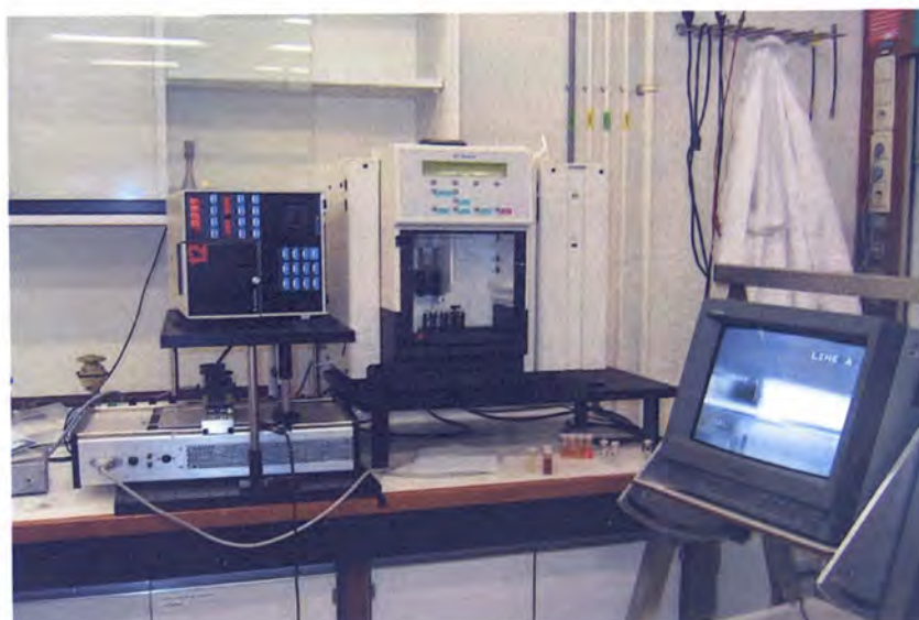
Figura IV.9. Imagen del equipo de CE con detección "on-line" UV e interfase para la posterior detección off-line mediante SERRS.
