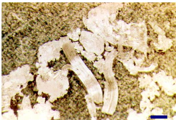
Figura 11.4. Microfotografía realizada con lupa binocular. Agregados subparalelos de cristales aciculares, triquitos y whiskers extraídos de las probetas n° 17 ( $KCl + KNO_3$ ) y n° 63 ( $Mg(NO_3)_2 \cdot 6H_2O$ ). La barra equivale a 1.5 mm.
