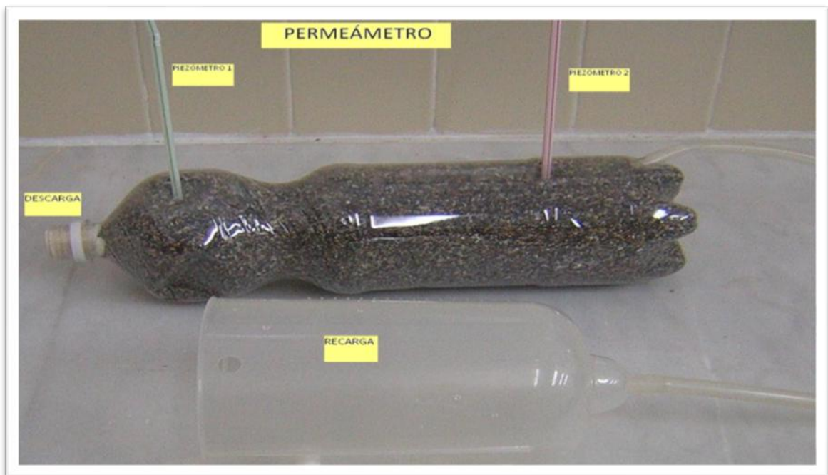
Figura 16. Imagen del permeámetro ideado.
