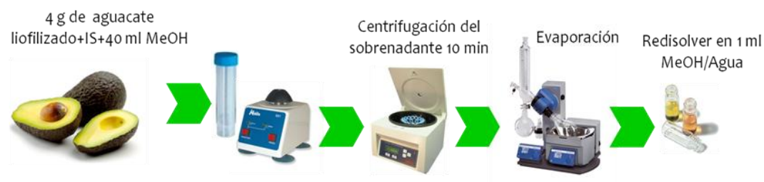
Fig. 103. Esquema que recoge todas las etapas del proceso de extracción
