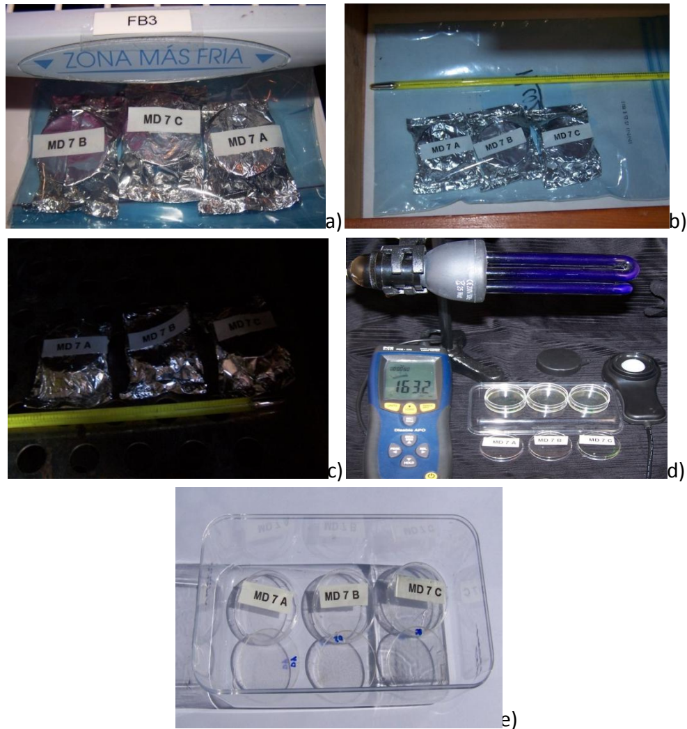
Fig. 63. Fotografías de los diferentes ambientes de conservación a los que se sometieron las fases sensoras para realizar el estudio de estabilidad a) 4° C en ausencia de luz, 24-b) temperatura ambiente (20° C, aprox) en ausencia de luz, 24-c) 35° C en ausencia de luz, 24-d) luz UV continua, e) luz solar continua.
