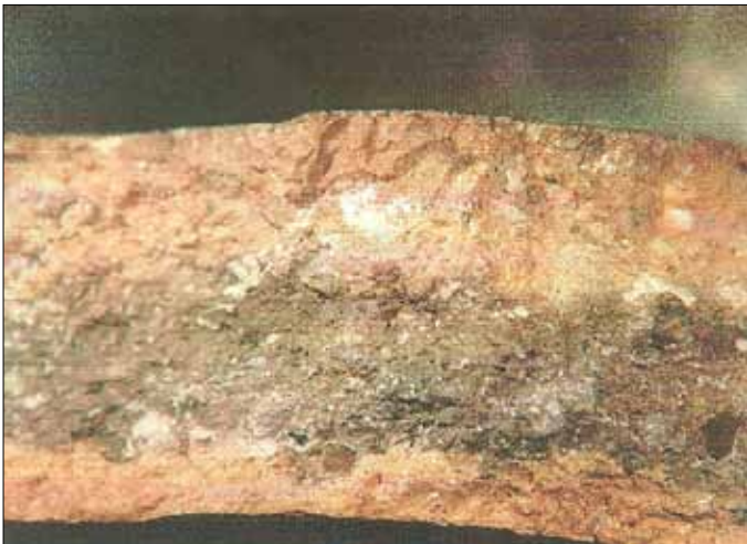
FIG. 11.1.3.5.4. Carbonatos secundarios presentes en la matriz cerámica
