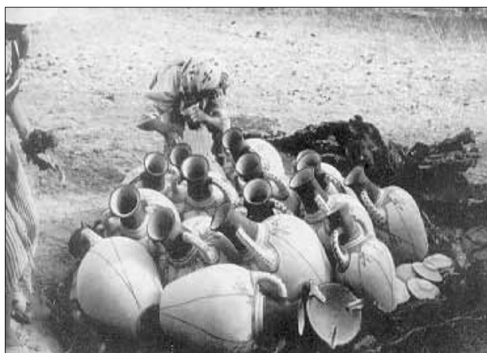
FIG. 12.1.3.1. Cocción al aire libre en Slit (Marruecos). Fotos: I. Schütz
