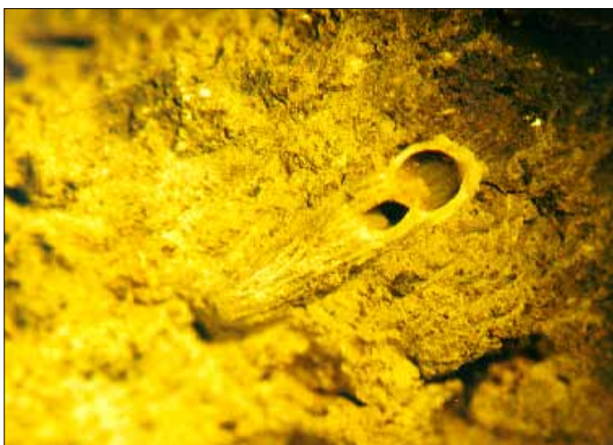
FIG. 8.2.1.1.25. Fotografías de foraminiferos en la matriz cerámica de las piezas 40785 y 41268
