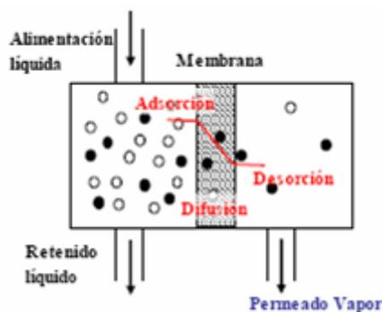
**Figura 65.** Diagrama del mecanismo de pervaporación a través de una membrana.
