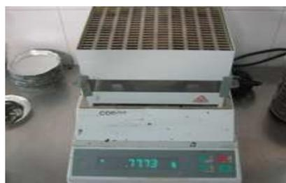
**Figura 28.** Fotografía Balanza COBOS para determinar la humedad. el uso de la balanza para hallar el contenido de humedad es determinante para el control de calidad.
