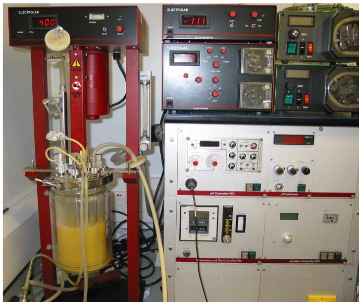
**Figura 24.** Fermentador (Electrolab) volumen 2 litros.
