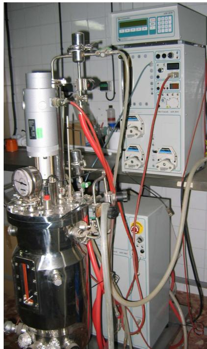
Figura 25. Fotografías biorreactor de 20 l Applikon
