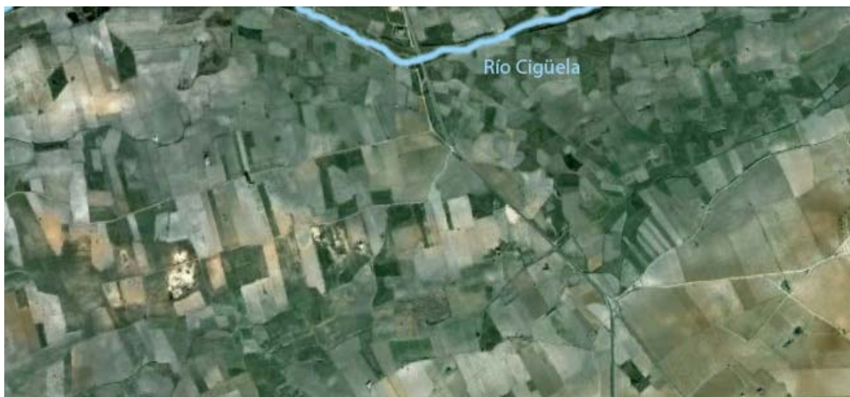
Ilustración 69: Zona de regadío en Villarrubia de los Ojos. Se detecta que la superficie de las parcelas es inferior al resto y su trazado sinuoso, para seguir el de las acequias
