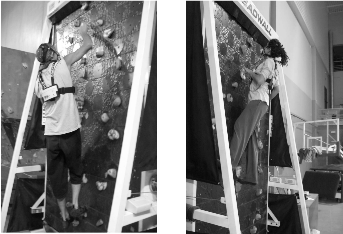
Figura 4. Medición del consumo máximo (pico) de oxígeno en un ergómetro específico de escalada, utilizando un analizador de gases portátil.
