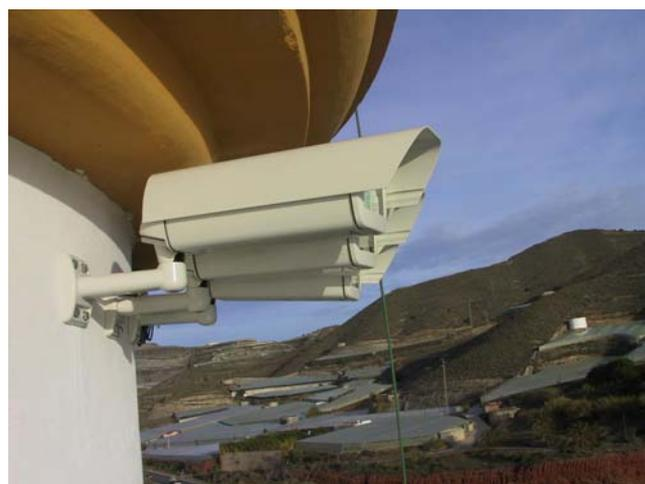
Figura 6: Cámaras de la estación de monitorización costera instalada en el Faro de Sacratif.
