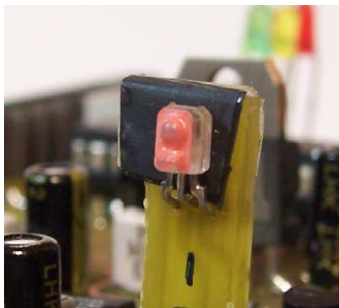
Figura 1. Fotodetector recubierto con la membrana sensora de oxígeno
