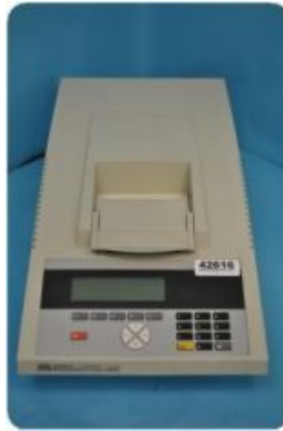
Figura 12. Termociclador Gene Amp PCR Systems 2400.
