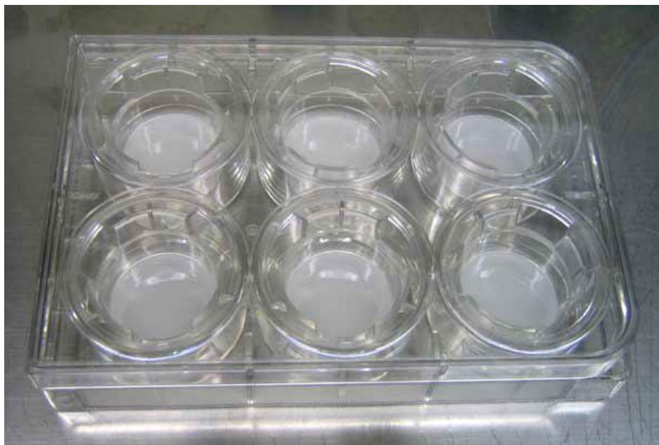
FIGURA 82: Sistema de cultivo Transwell® con membranas porosas de 0,4 \mu\text{m} (Costar, Corning Inc., Corning, Nueva York, EEUU).
