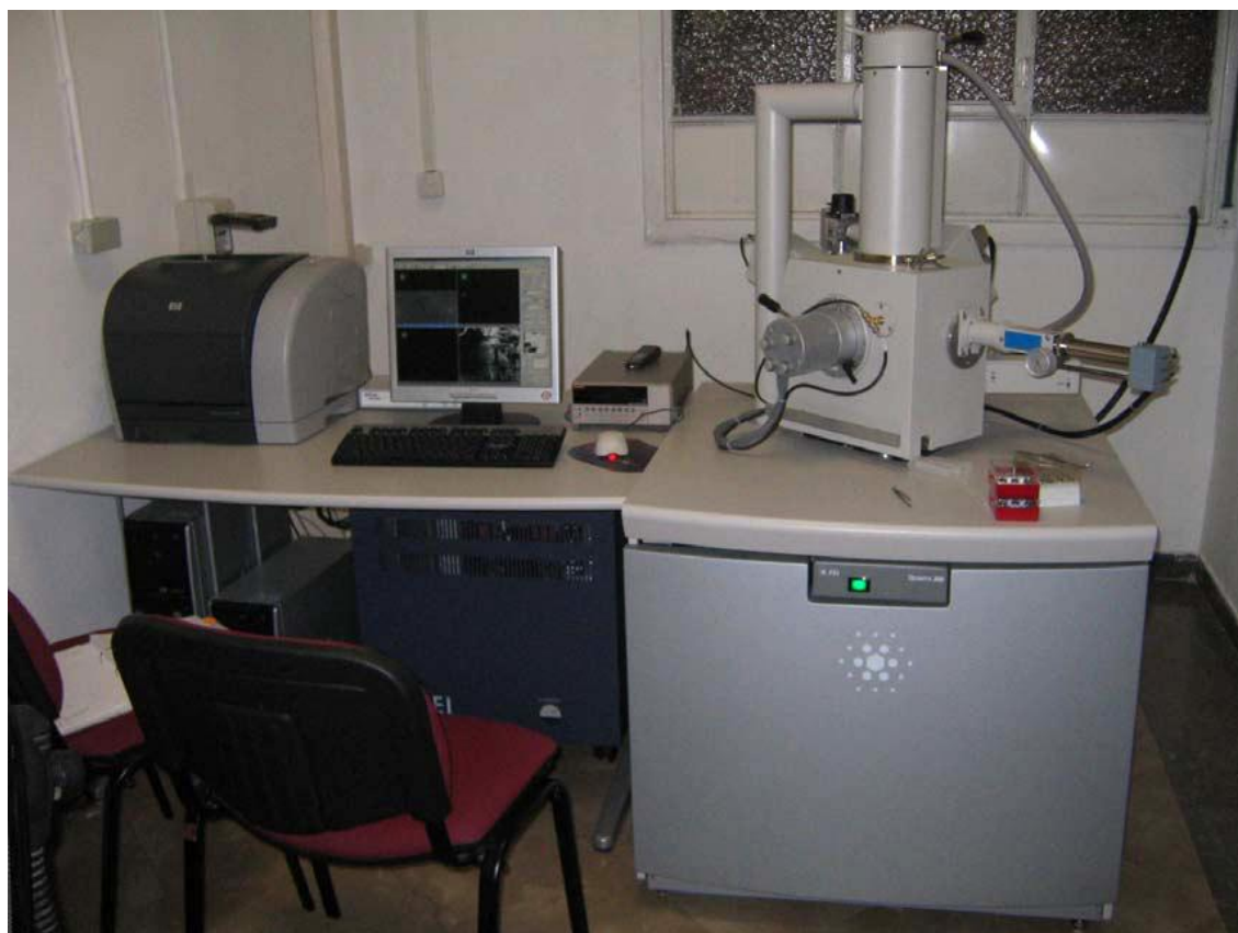
FIGURA 84: Microscopio electrónico de barrido FEI Quanta 200 utilizado en esta Tesis Doctoral.
