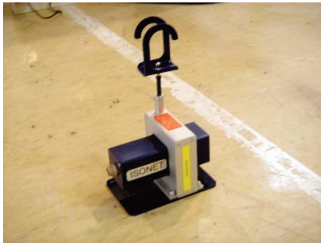
Figura 2.1a. Encoder del Sistema Isocontrol 3.6 plus (JLML) I+D.
