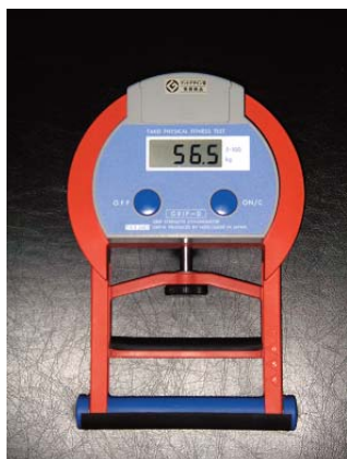
Figura 2.2. Dinamómetro digital Psymtec TKK-5101.
