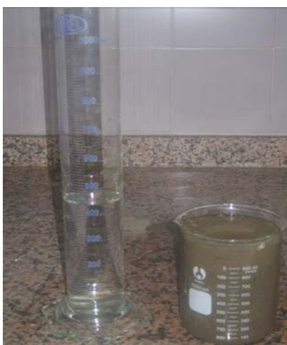
Fig 3.14. Vaso de precipitados y probeta empleadas en la determinación de la porosidad de las muestras de suelo utilizadas.
