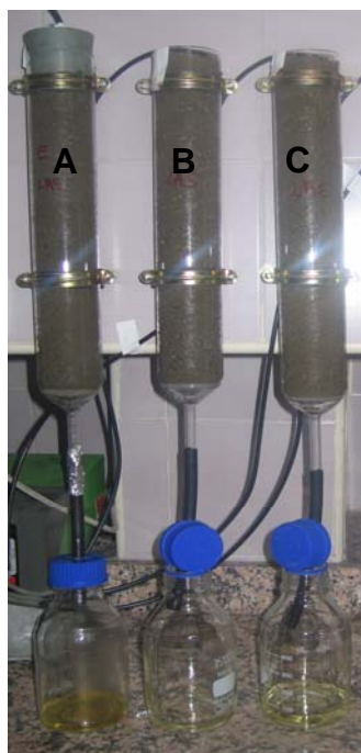
Fig 3.10. Fotografía que muestra los tres tipos de microcosmos ensayados una vez montados en laboratorio
