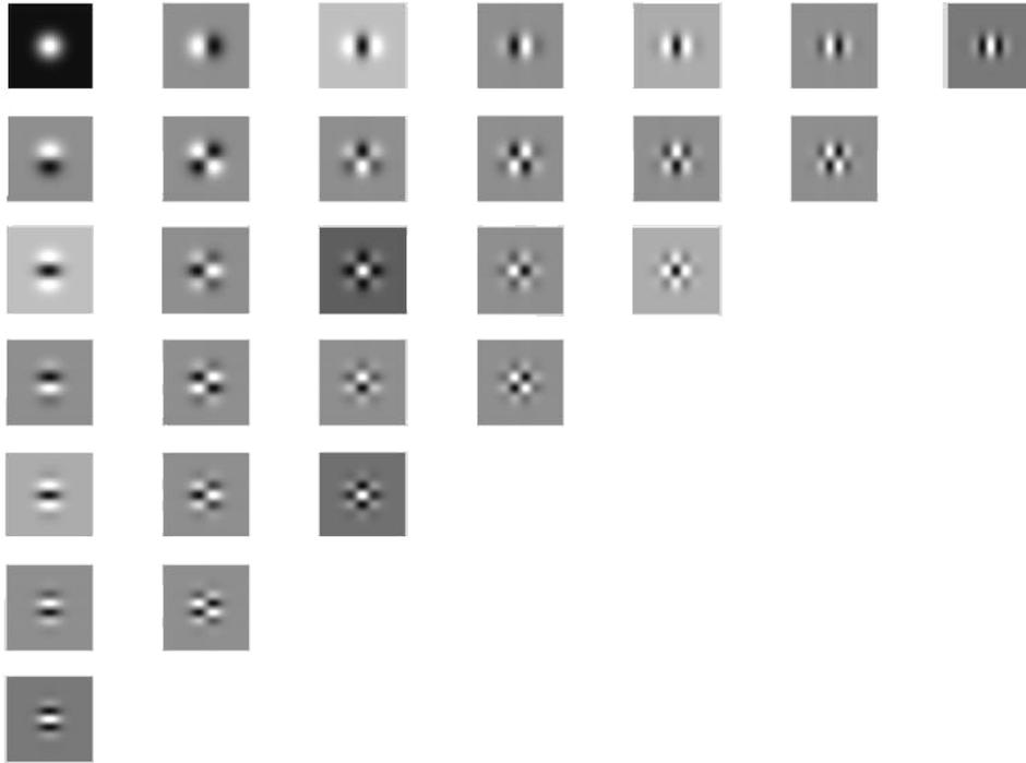
**Figura 3.4.** Estructura piramidal diseñada al efecto que servirá como banco de filtros bidimensional. (Nótese que aparecen las derivadas cruzadas de orden 0 hasta 6)
