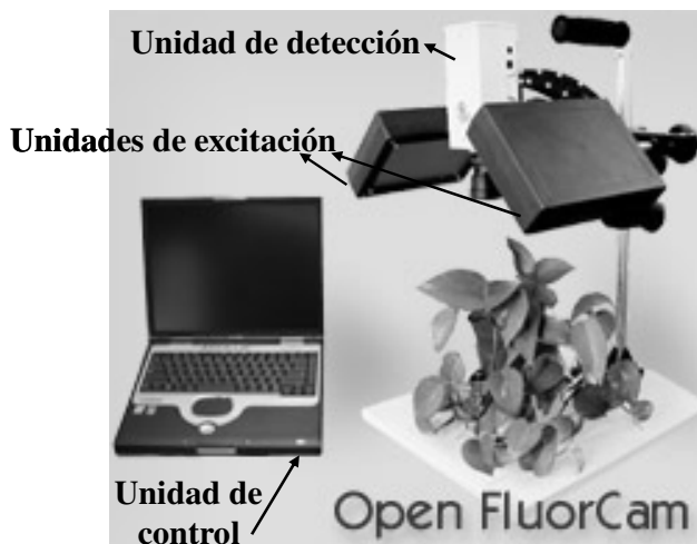
Fig. 18: Modelo abierto del FluorCam (PSI, www.psi.cz ) con sus distintos componentes.
