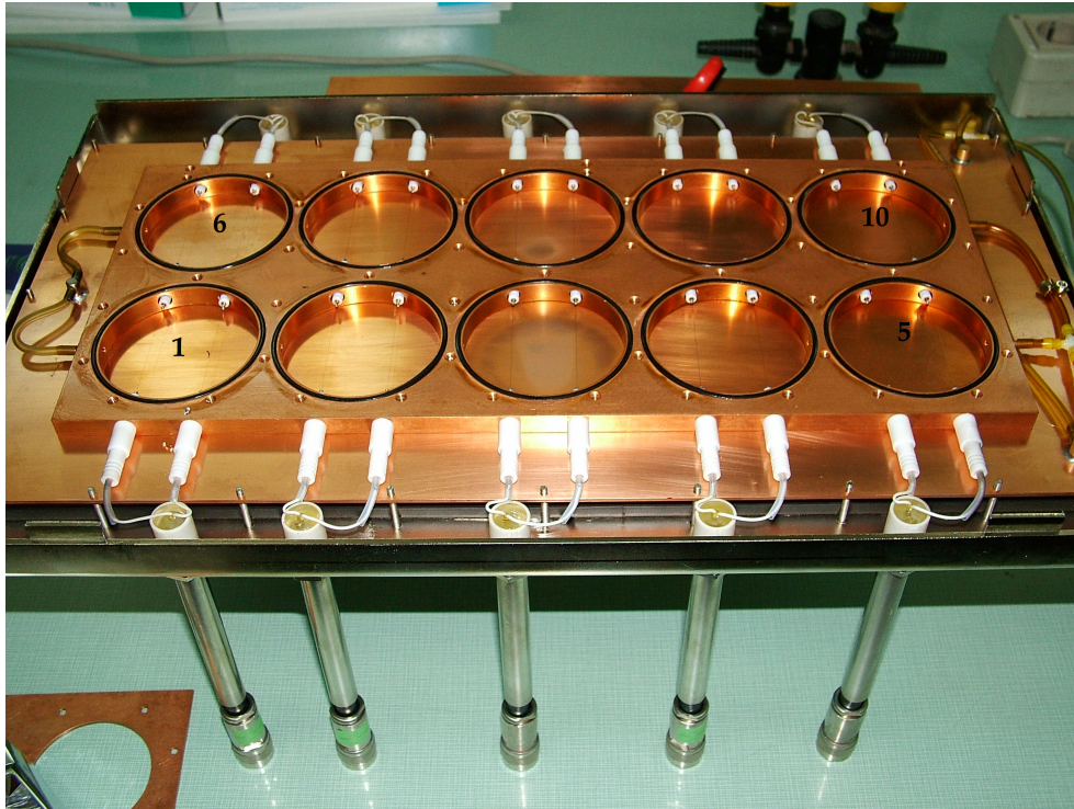
Figura 3.13. Disposición de la entrada y salida del gas PR-10 en el sistema de detección.
