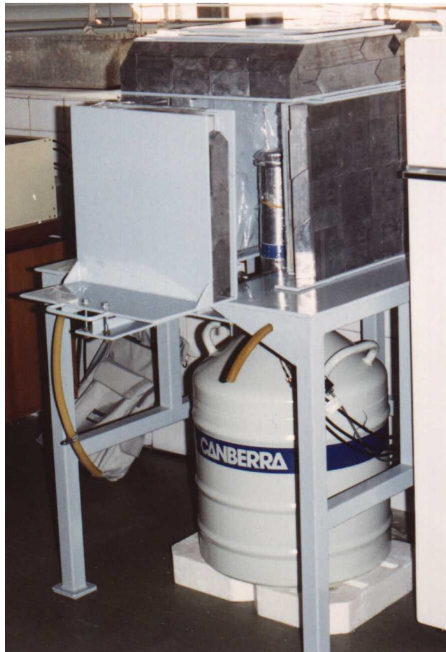
Figura 2.4. Blindaje del detector de Germanio.
