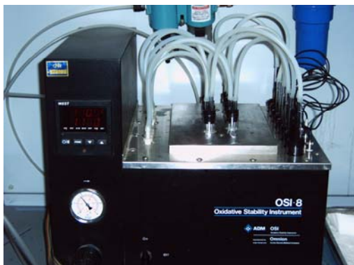
Fotografía del instrumento OSI empleado en el desarrollo experimental de este capítulo.
