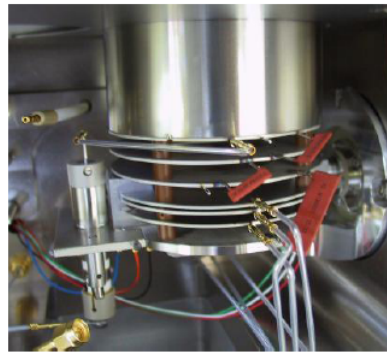
Figura. Imagen de la zona de aceleración ortogonal de un MicroTOF y esquema de sus componentes.
