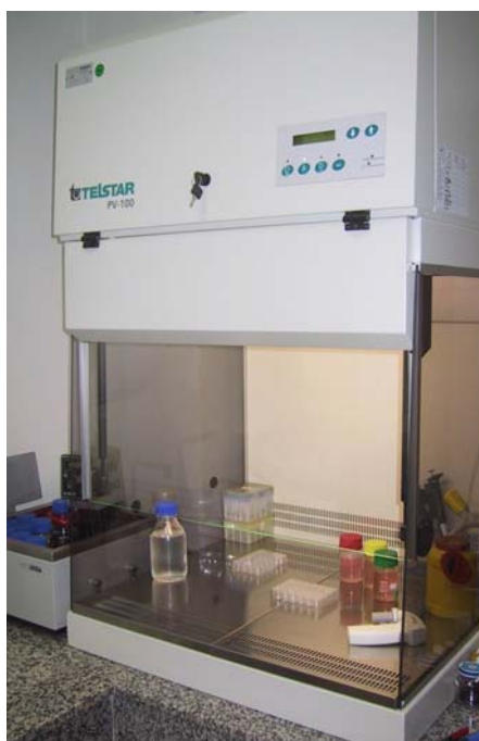
Figura 8.3. Cabina de flujo laminar vertical Telstar PV-100 instalada en nuestro laboratorio de cultivos para garantizar las condiciones de asepsia que requieren los cultivos de células animales.
