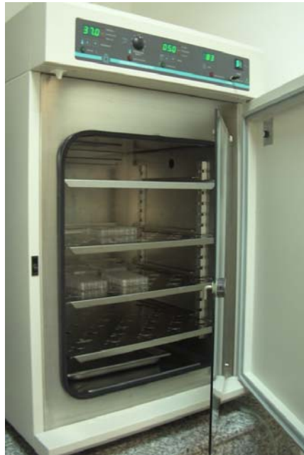
Figura 8.4. Incubador de CO 2 utilizado en nuestro laboratorio para mantener unas condiciones térmicas, de tensión de CO 2 y de humedad constantes durante el cultivo de células animales.
