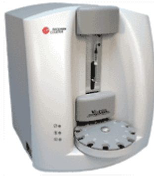
Figura 8.18. Analizador de viabilidad celular. El Vi-Cell automatiza el método manual de determinación de viabilidad por el método de tinción con azul Tripán. El Vi-Cell aspira la muestra colocada en un vial en el automuestreador y la mezcla con azul Tripán al 0.4%. Las células se hacen pasar entonces por una celda de flujo mientras se toman imágenes con una cámara en tiempo real. Una serie de algoritmos desarrollados por Beckman Coulter determinan si las células han absorbido el tinte o no. Las células que absorben el azul Tripán aparecen más oscuras y proporcionan un valor menor en la escala de grises. Las células con valores en la escala de grises mayores se consideran viables.
