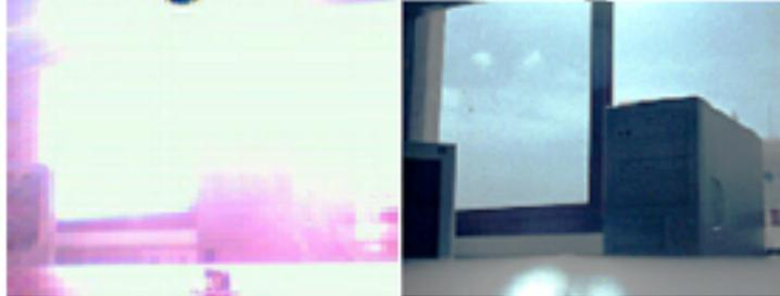
**Figura 3.3:** Diferencia en la captura de imágenes por una cámara CCD lineal (izquierda) y una cámara CMOS logarítmica (derecha). Gracias a la compresión logarítmica es posible captar en la misma imagen (sin saturación) zonas que difieren en varios órdenes de magnitud en intensidad luminosa.
