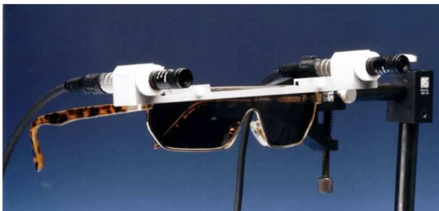
**Figura 2.34:** Soporte para las cámaras de EAV.
