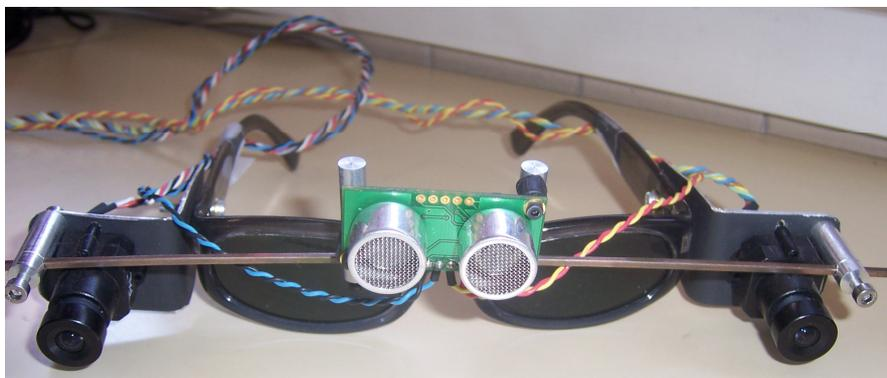
**Figura 6.24:** Dispositivo de captura de imágenes utilizado en VISION2SOUND. En la zona central podemos distinguir el sensor de ultrasonidos incorporado.
