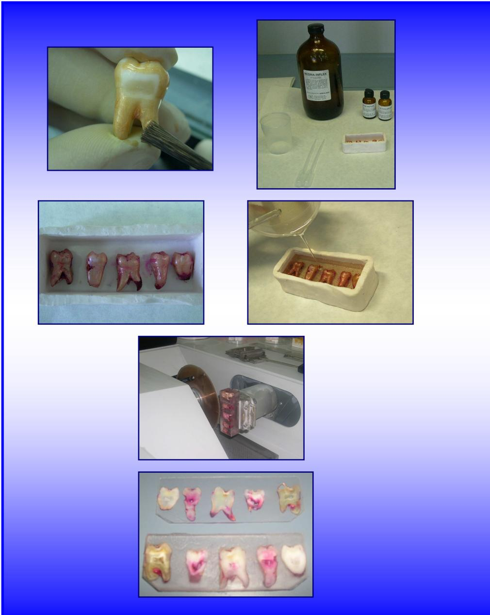
Fig. 30. Inclusión y corte de los especímenes para ser observados en el Estereomicroscopio
