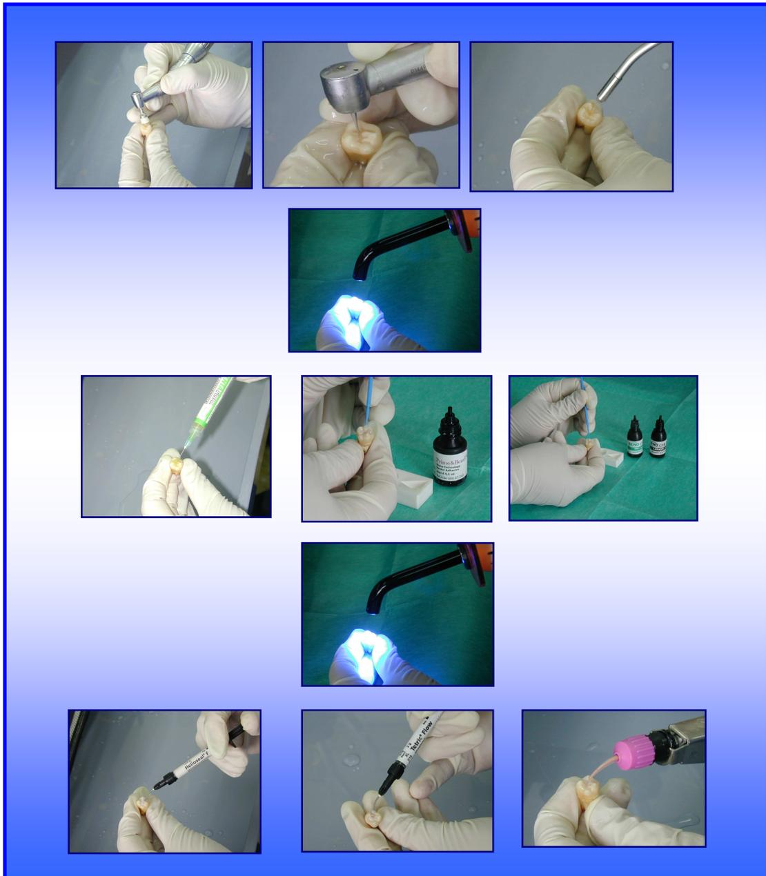
Fig. 14. Preparación de los especímenes, de acuerdo a las instrucciones de la casa fabricante
