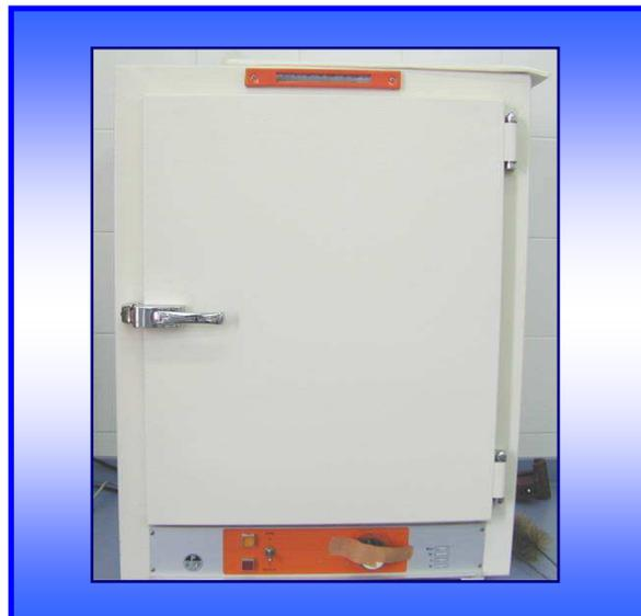
Fig. 16. Estufa para el almacenamiento de los especímenes
