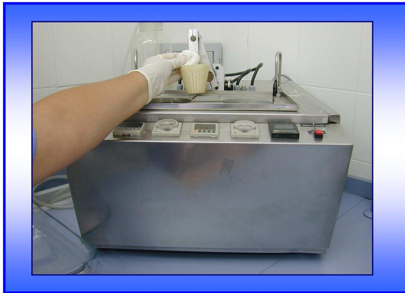
Fig. 18. Termocicladora utilizada en la investigación
