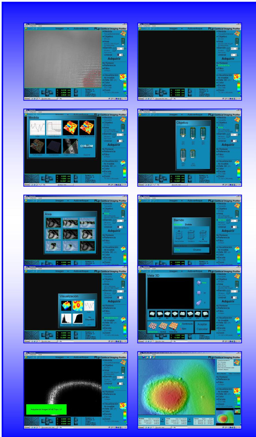
Fig. 10. Secuencia del procedimiento para la obtención de imágenes de las distintas gotas con el Microscopio Confocal y Software PLu Confocal Imaging Profile
