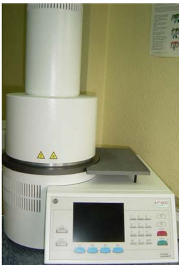
Sin dejar que el revestimiento se enfriara se colocaron en el horno de inyección IPS Empress EP 600 (Ivoclar-Vivadent, Liechtenstein) (Figura18), en el que bajo condiciones de vacío se inyectó a presión una o dos pastillas de cerámica, según el número de patrones de cera que se hubieran revestido. Estas habían sido calentadas previamente en el horno de precalentamiento Vulcan 3-550.
