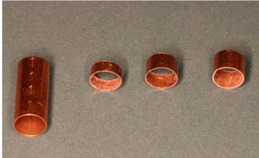
Figura 20. Aros de cobre cortados a 2, 3 y 4mm de altura empleados como preforma interna para confeccionar los moldes de silicona
