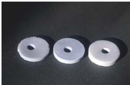
Figura 23. Moldes de silicona de 2, 3 y 4mm de altura ya terminados
