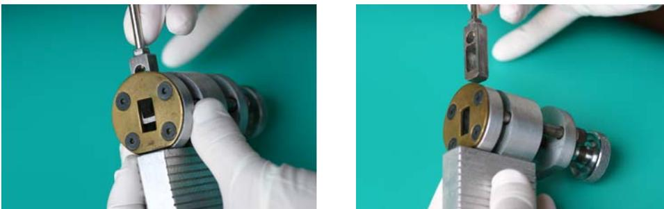
Figura 33. Elemento móvil de la mordaza encargado de transmitir la fuerza de cizalla a la interfase adhesiva
