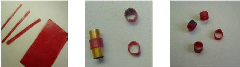
Figura 14. Fabricación de los patrones de cera para inyectar la cerámica y obtener los moldes de porcelana
