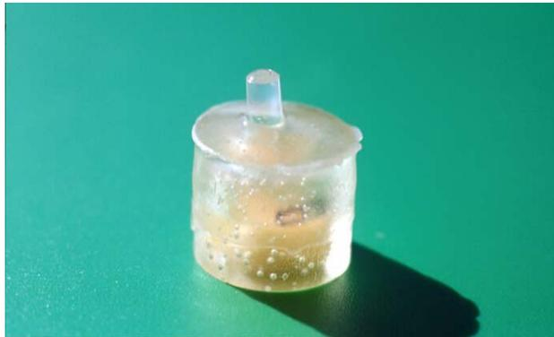
Figura 11. Muestra y cámara pulpar artificial incluidos conjuntamente
