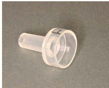
Figura 9. Extremo troncocónico de una jeringa de 2cm que simulará la cámara pulpar artificial
