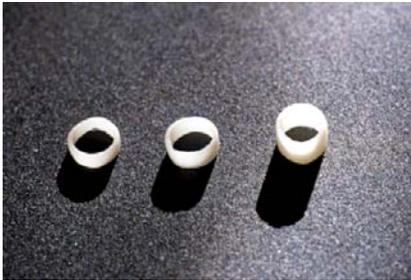
Figura 19. Aros de porcelana de 2, 3 y 4mm de altura, limpios de material de revestimiento
