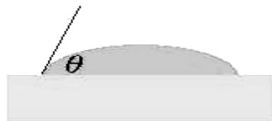
Fig. 3.1.2- Esquema de funcionamiento de un goniómetro (tomado de Busscher, 1985).
