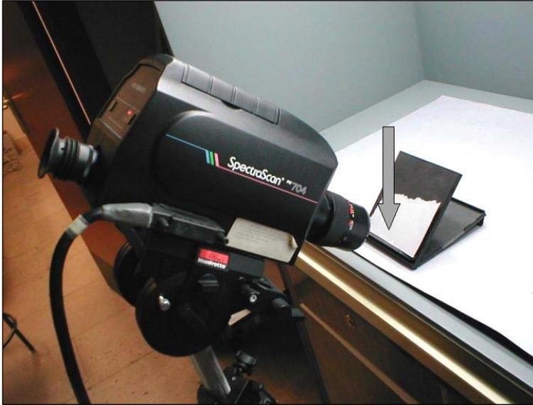
Fig 1.1.5- Análisis colorimétrico de una de las muestras (señalada con una flecha).
