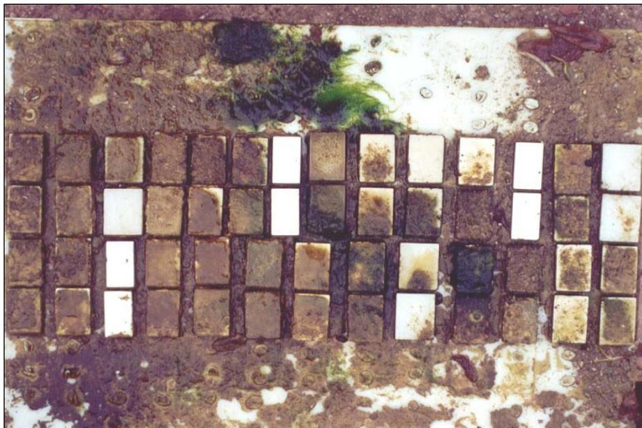
Fig. 2.2.6- Estado del dispositivo experimental para evaluar la susceptibilidad de los diferentes materiales a la colonización por microalgas, momentos antes de la tercera recogida de probetas. Las probetas menos colonizadas corresponden a los materiales naturales.
