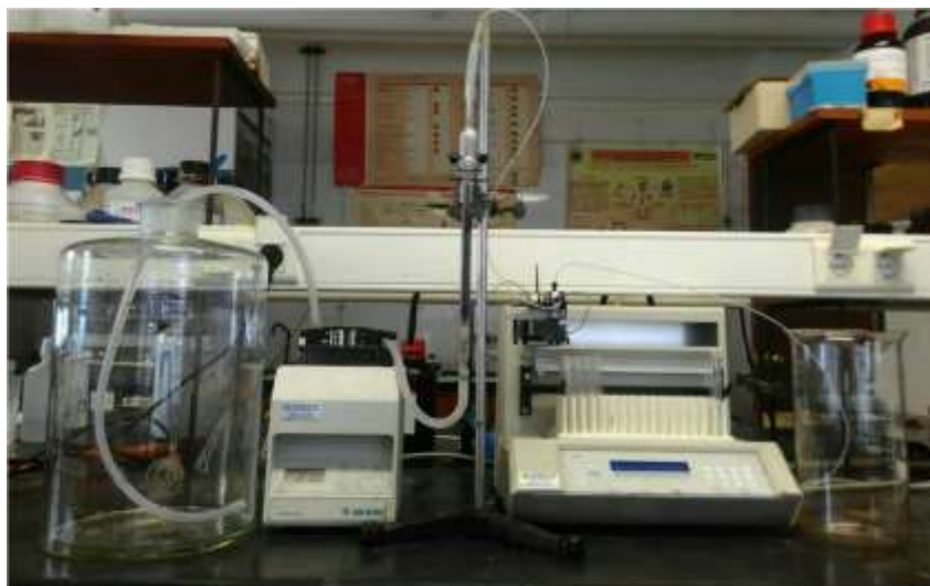
Fig. 2-7. Fotografía del diseño experimental utilizado para los estudios de adsorción de iones metálicos en flujo continuo empleando una columna de lecho fijo.
