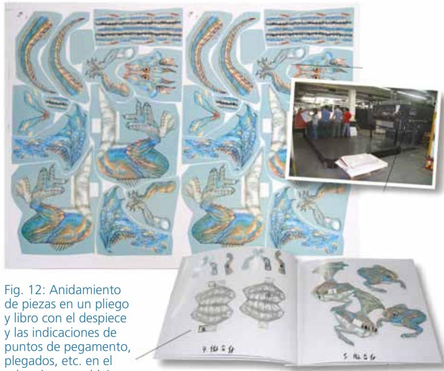
Fig. 12: Anidamiento de piezas en un pliego y libro con el despiece y las indicaciones de puntos de pegamento, plegados, etc. en el orden de ensamblaje.
