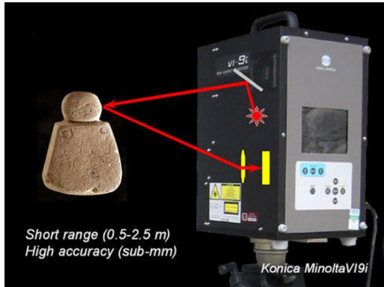
Imagen 51. Síntesis del proceso de triangulación por láser, mediante un escáner Konica Minolta.
