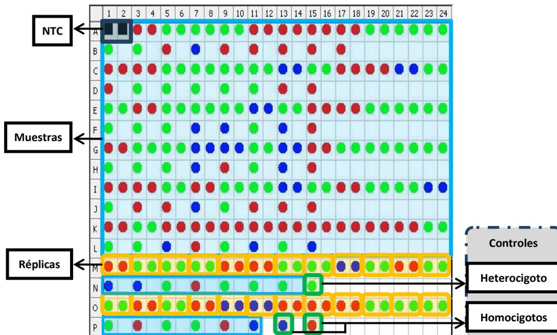
Figura 11. Representación esquemática de la localización de cada uno de los tipos de muestras que hay que incluir en una placa óptica para PCR de 384 pocillos.
