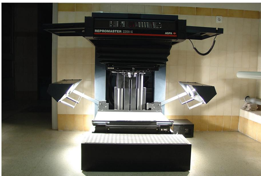
Figura 55: Cámara reprográfica: utilizada para la fotoreproducción de originales en línea, tono continuo y color, puede realizar ampliaciones y reducciones, así como tramado y separación de color.
