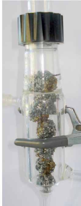
Fig. 2.10. Detalle del sistema BSF. Disposición del sustrato ensuciado en la columna
