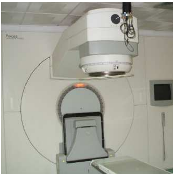
Figura 5.1: Acelerador lineal de uso clínico Elekta Precise empleado en los tratamientos de SRS en el Instituto Nacional de Oncología y Radiobiología La Habana (Cuba).
