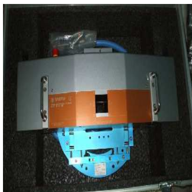
Figura 5.2: Colimador micro-multilamina dinámico empleado en los tratamientos de SRS en el Instituto Nacional de Oncología y Radiobiología (La Habana, Cuba)
