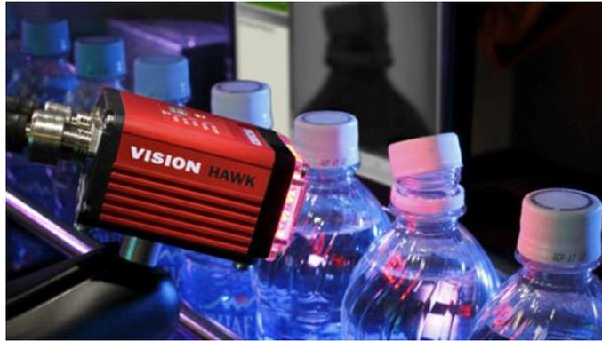
**Figura 2.3.** Un ejemplo de un sistema de inspección industrial basado en visión artificial instalado en la cadena de producción. (Cortesía de Microscan Systems Inc.).
