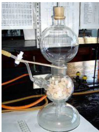
Figura 1. Montaje básico de laboratorio (Aparato de Kipp) para la síntesis del gas \text{CO}_2 .
