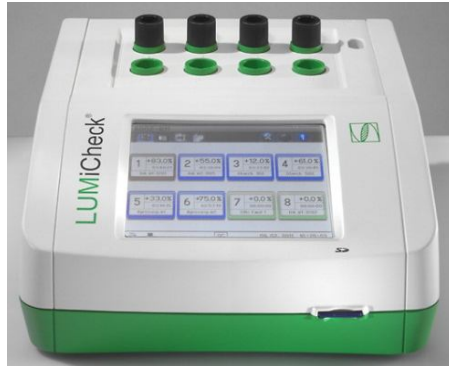
Figura 21 - Equipamento LUMiCheck® usado para a análise da estabilidade de emulsões.
