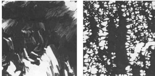
**Figura I.20.** Texturas típicas de cristales líquidos laminares (izquierda) y hexagonales (derecha).
