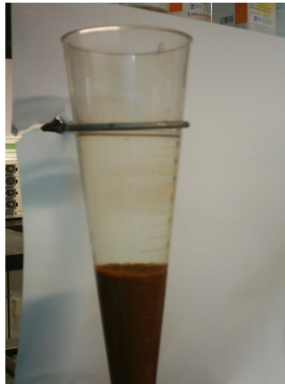
Figura II.7. Durante una experimentación en discontinuo, etapa de sedimentación.
