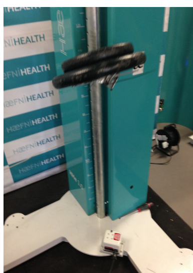
Figura 1. Imagen del dispositivo de desplazamiento lineal enganchado al extremo distal del dispositivo Haefni Health System 1.0.
