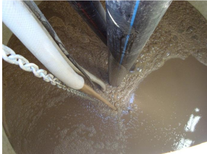
Figura 3.1. Llenado inicial de la instalación de UF con fango biológico procedente del espesador de flotación de la EDAR Granada-Sur.
