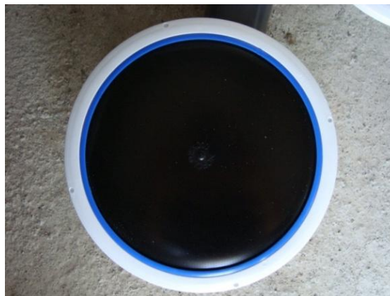
Figura 3.4. Difusor de aire utilizado en el biorreactor de la instalación de MF.
