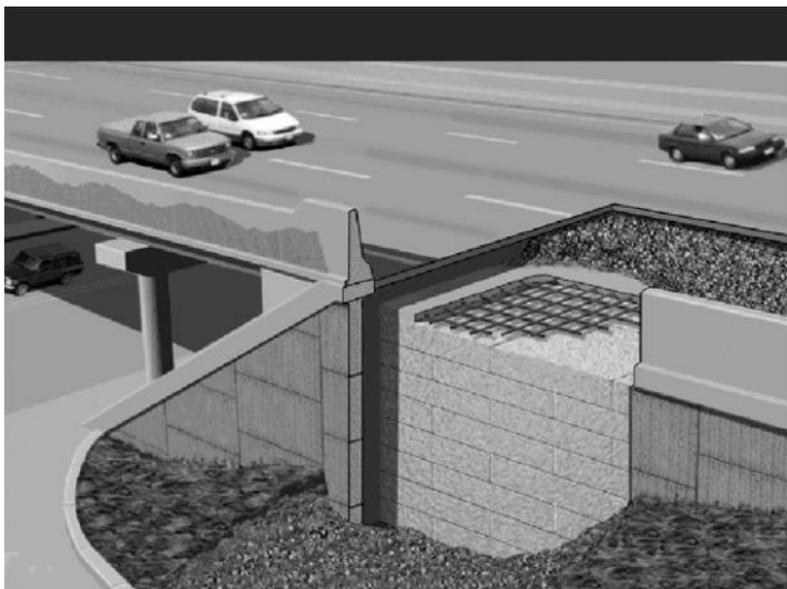
**Figura 2-18: Relleno del trasdos con bloques ligeros.**
