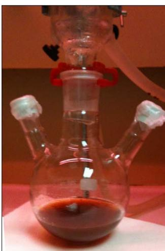
La mezcla de reacción se mantuvo a reflujo durante 25 minutos al cabo de los cuales se extrajo el matraz del baño de glicerina y se dejó enfriar el contenido a temperatura ambiente (ver figura adjunta). Luego, la mezcla se diluyó con los 450 mL de agua que se había barboteado con N<sub>2</sub>.
