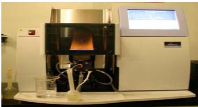
Figura 8. Espectrofotómetro de Absorción Atómica
