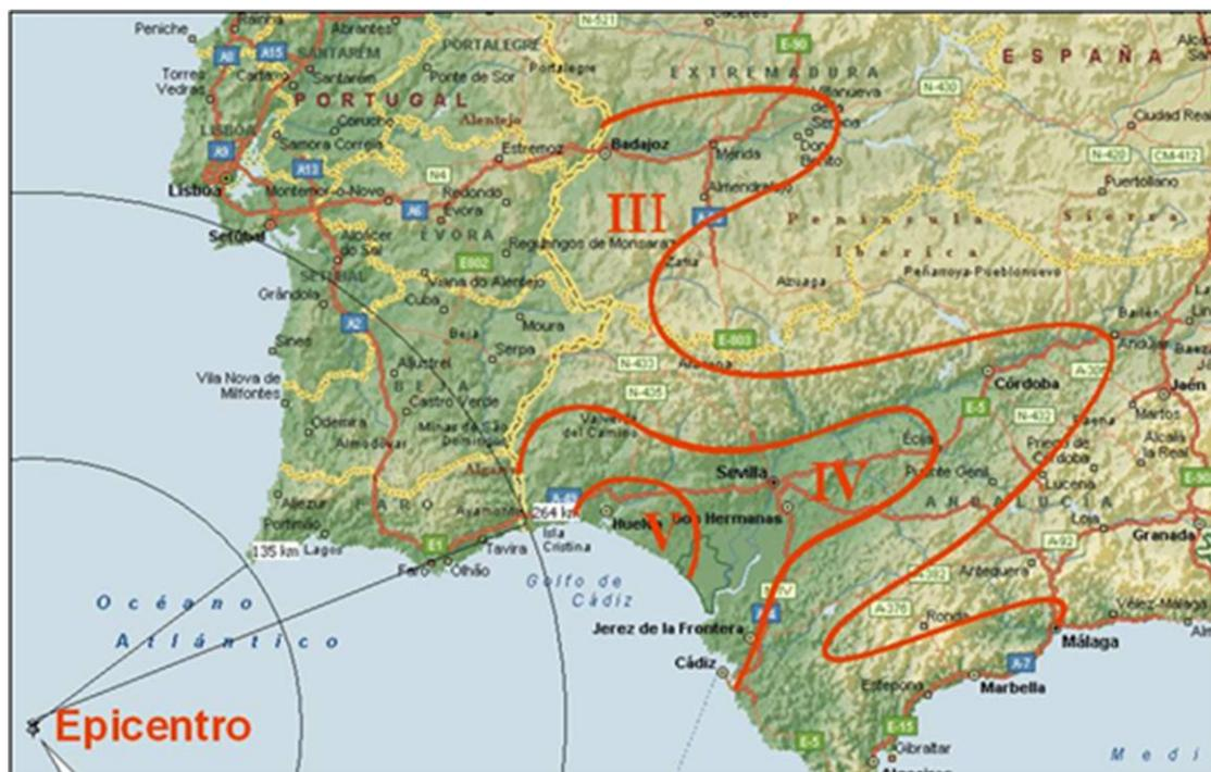
Figura 2.9: Mapa de isosistas en el que se pueden apreciar efectos de amplificación de la sacudida en el valle del Guadalquivir (Terremoto del 12-2-2007. Mw= 6.2. Base de datos Macrosísmicos del IAGPDS)
