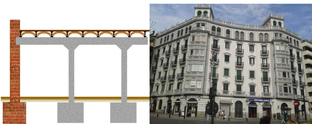
*Figura 4: A la izquierda, gráfico de tipología M3.3 de muros de carga con pórticos de hormigón ligeramente armado, forjados de vigueta metálica y revoltones de ladrillo cerámico. Derecha: Edificio de esta tipología en Avenida de Constitución*
