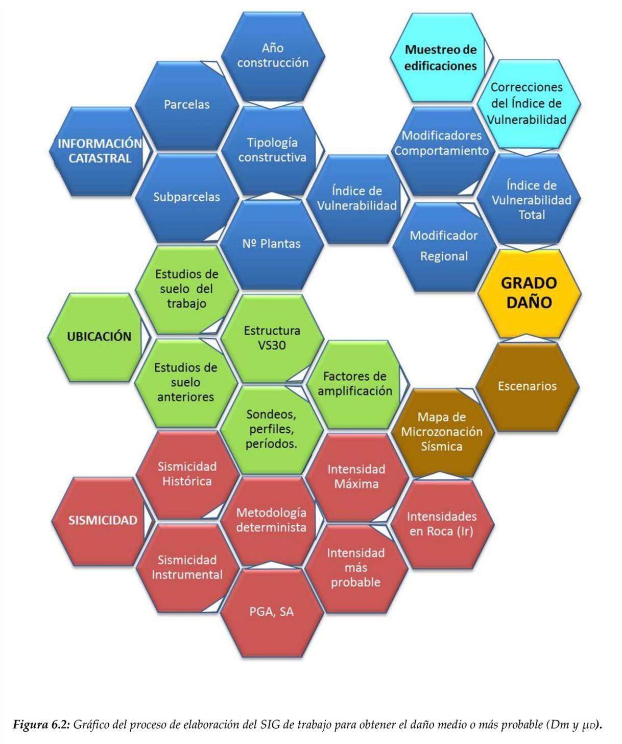
Figura 6.2: Gráfico del proceso de elaboración del SIG de trabajo para obtener el daño medio o más probable ( $D_m$  y  $\mu_D$ ).
