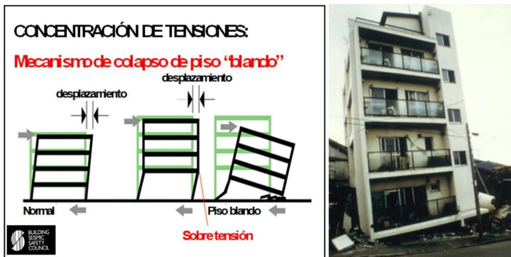
Figura 4.22: Mecanismo de colapso de piso blando (BSSC) y ejemplo en el terremoto de Kobe (Japón, 1995) (EMS-98)
