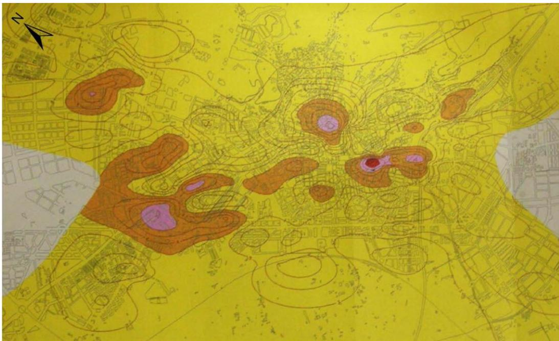
Figuras 3.18: Plano de espesor del material de relleno (Hernández del Pozo, 1998)
