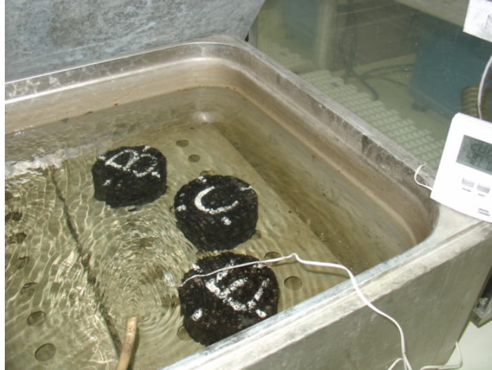
Figura 21. Probetas grupo húmedo del ensayo de sensibilidad al agua en baño de agua a 40°C
