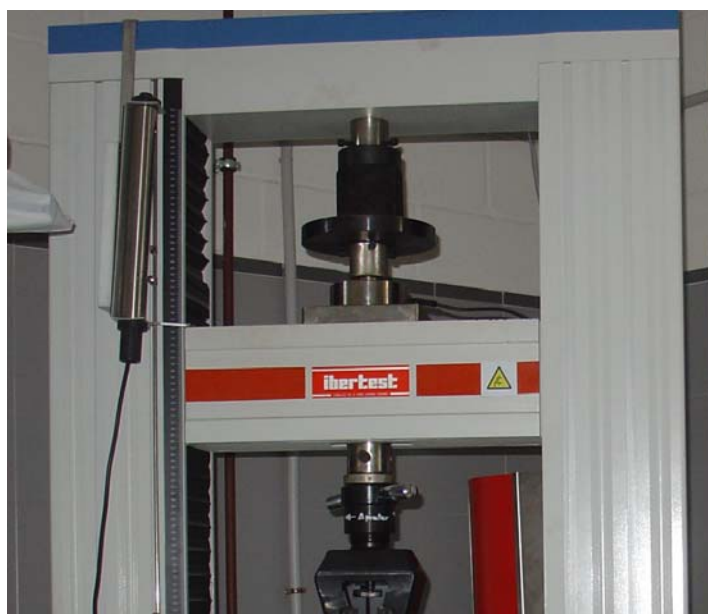
Figura 14. Rotura probetas en el ensayo de inmersión-compresión
