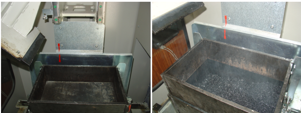
Figura 28. Compactación probetas del ensayo de rodadura
