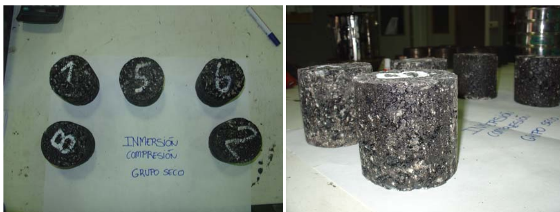
Figura 13. Probetas grupo seco del ensayo de inmersión-compresión
