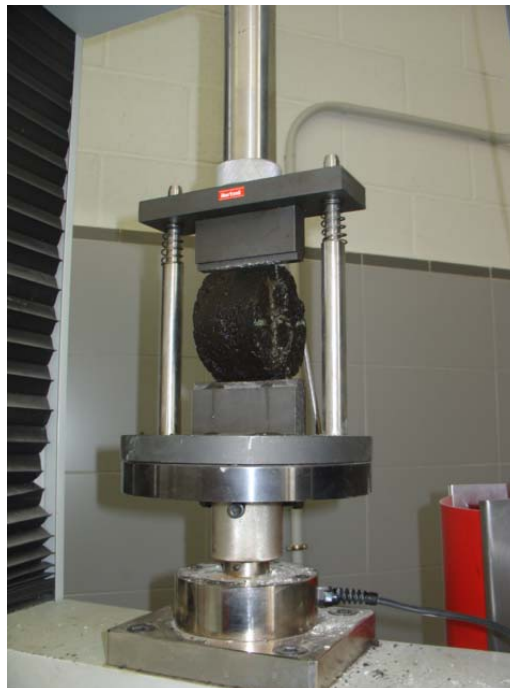
Figura 22. Rotura probetas en el ensayo de sensibilidad al agua
