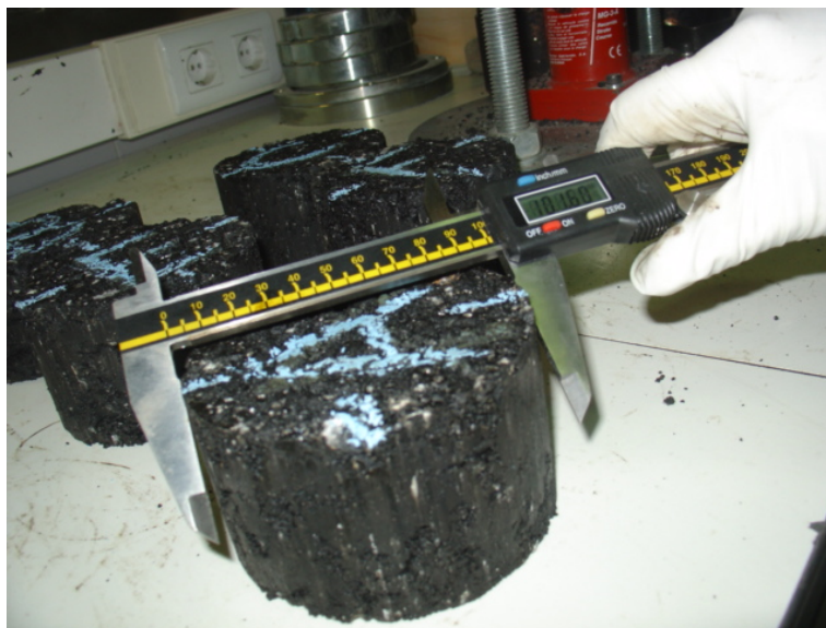
Figura 17. Toma dimensiones probetas del ensayo de sensibilidad al agua
