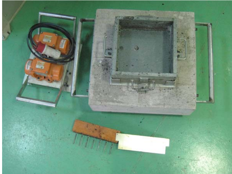
Figura 7. Equipo de compactación NLT 173
