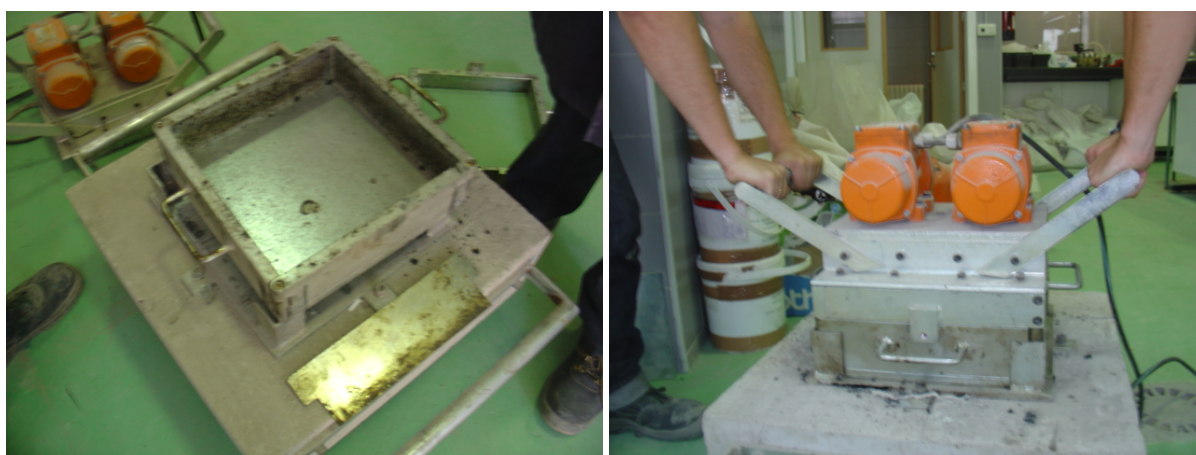
Figura 25. Compactación probetas del ensayo en pista
