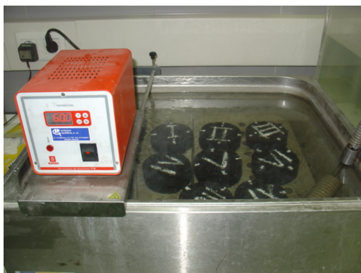
Figura 15. Probetas grupo húmedo del ensayo de inmersión-compresión
