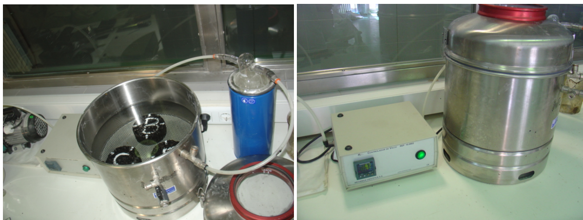
Figura 20. Probetas grupo húmedo del ensayo de sensibilidad al agua en recipiente de vacío
