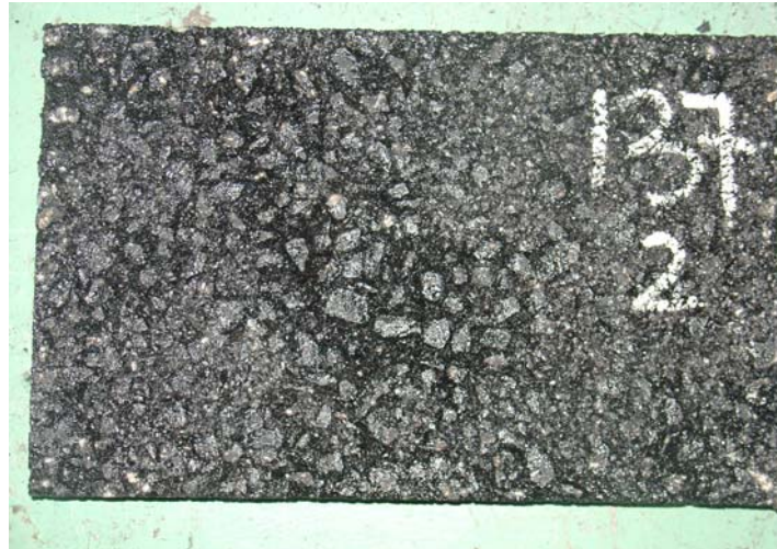
Figura 29. Probeta del ensayo de rodadura
