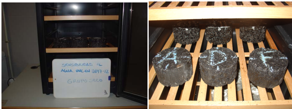
Figura 19. Probetas grupo seco del ensayo de sensibilidad al agua
